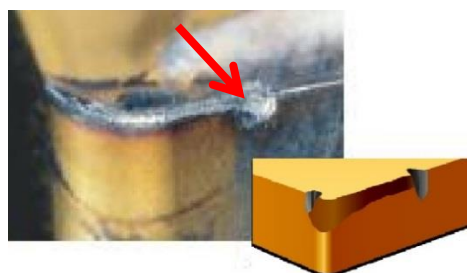
Figura 2.9 – Desgaste de entalhe
