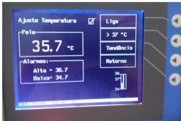
Figura 4.7:Tela para configuração da temperatura do Modo PELE
