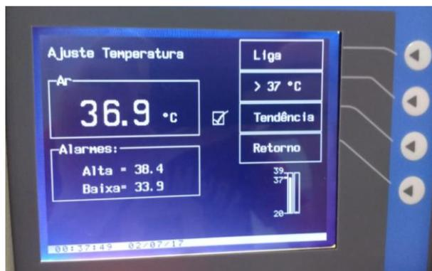
Figura 4.8:Tela para configuração da temperatura do Modo AR
