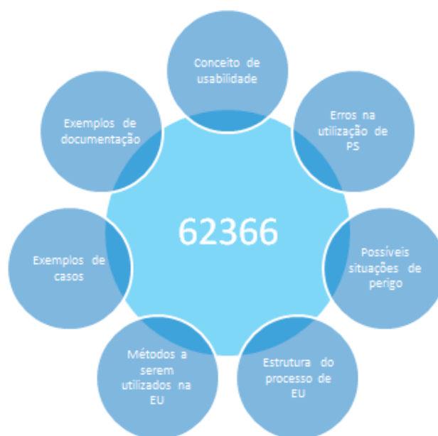
Figura 2.19 – Informações contidas na norma IEC 62366 para suporte na implantação do processo de EU
