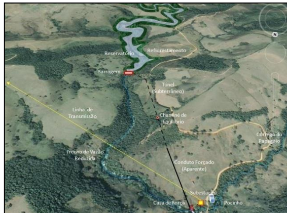
Figura 2: Arranjo ilustrativo da PCH Aiuruoca.
