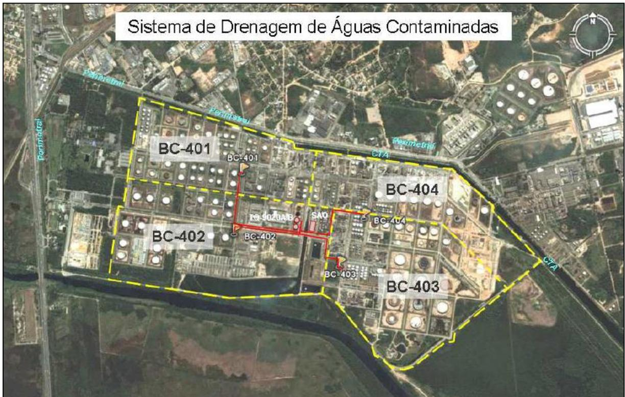
**FIGURA 4.3:** Sistema de Drenagem de Águas Contaminadas REDUC (Fonte: PETROBRAS, 2010g, p. 10).
