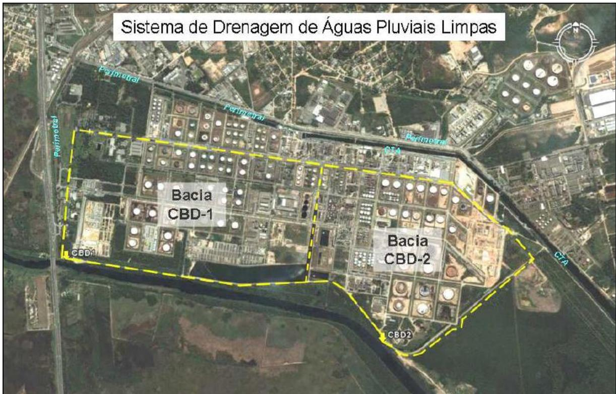
**FIGURA 4.2:** Sistema de Drenagem de Águas Pluviais Limpas REDUC (Fonte: PETROBRAS, 2010g, p. 6).
