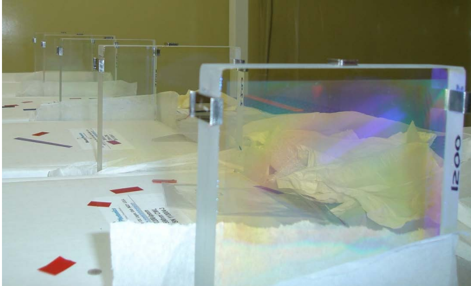
Figura 2.10 – Redes VPH do espectrógrafo SIFS.
