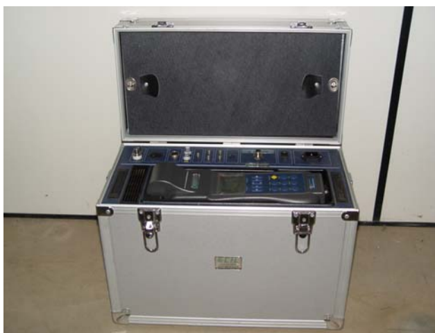
Figura 10.6 Equipamento para análise de gases de combustão.
