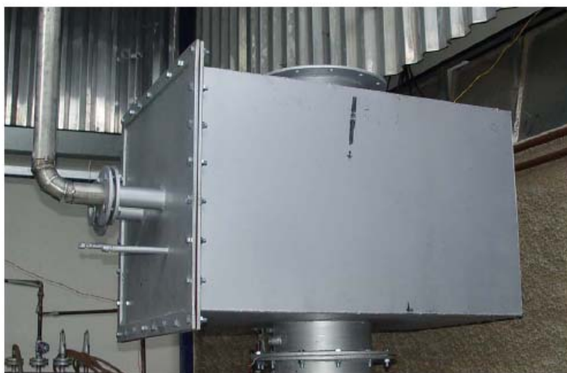
Figura 8.3 - Foto do reformador catalítico.
