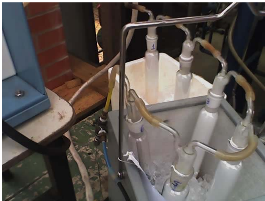
Figura 4.7 – Foto apresentando o gás sendo amostrado, no interior dos “impingers”, durante um dos testes.
