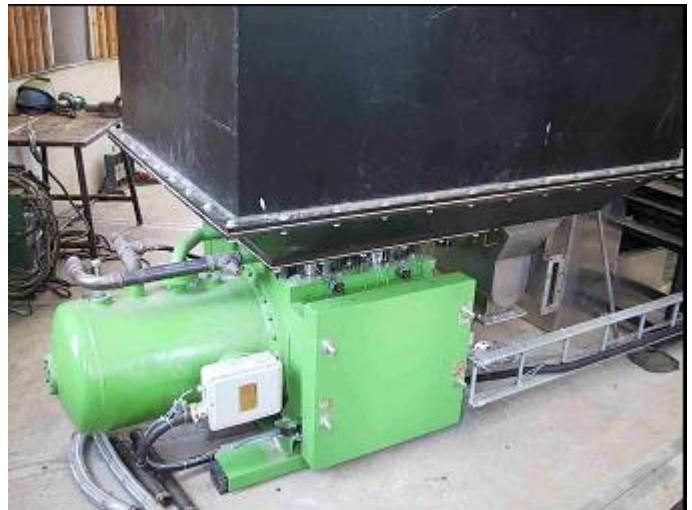
Figura 1.44 - Sistema de geração gaseificador / motor Stirling (Jensen, 2002)
