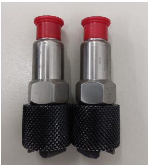
Figura 38 - Acelerômetro acoplado a base magnética (Fonte: própria).
