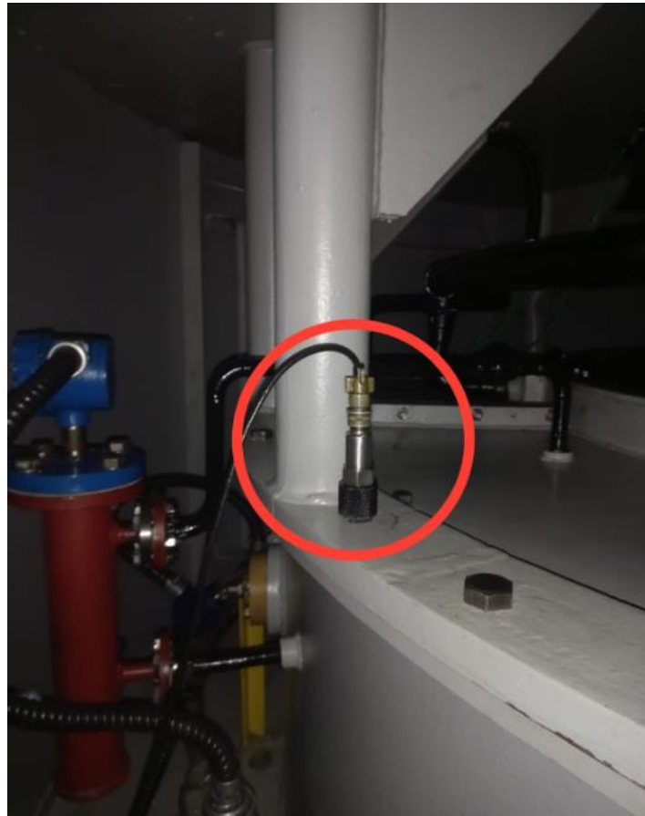
Figura 35 - Acelerômetro montado axialmente em estrutura rígida próxima ao mancal de escora, posição montante (Fonte: própria).
