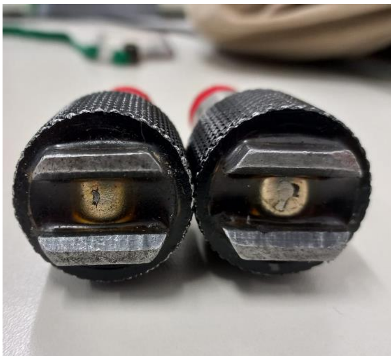
Figura 37- Base magnética para acelerômetro (Fonte: própria).
