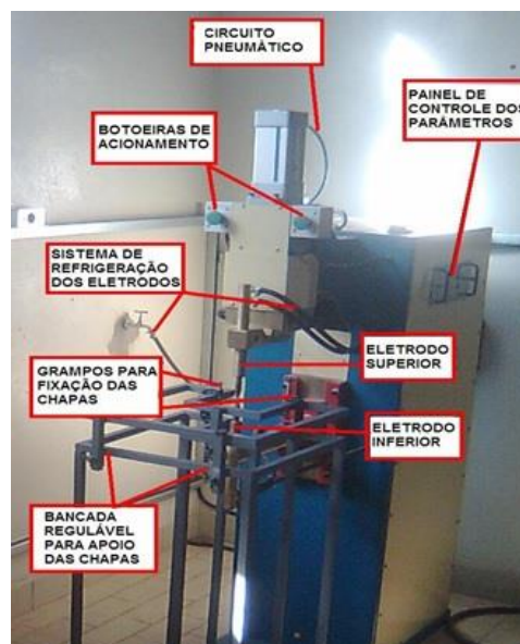
Figura 3.4 – Detalhes do equipamento de soldagem RSW utilizado
