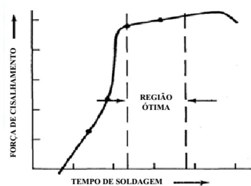
Figura 2.4 – Resistência ao cisalhamento em função do tempo de soldagem
