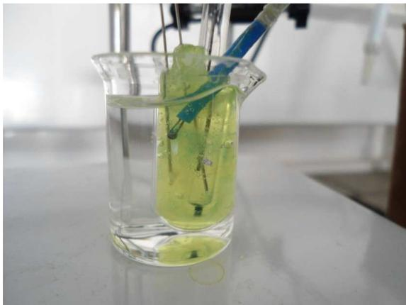
Figura 24: Fotografia ilustrativa da montagem utilizada para determinação da temperatura de transição LCST por VC.
