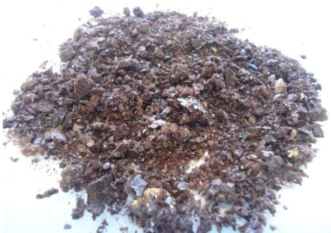
Figura 21: Complexo SC-NPsAg após liofilização.
