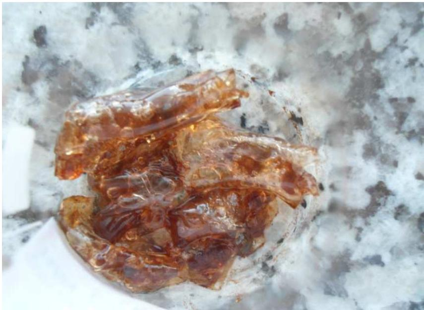
Figura 22: Hidrogéis de Pnipam VC em processo de intumescimento com a solução de SC-NPsAg.
