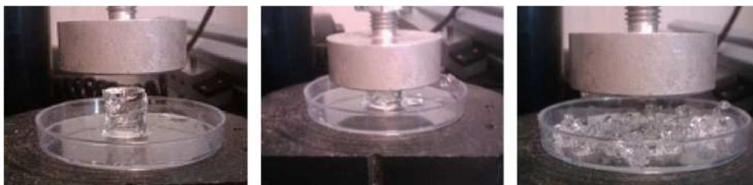
Figura 48: Imagem representativa da deformação sofrida pelo hidrogel quando aplicada força de compressão.
