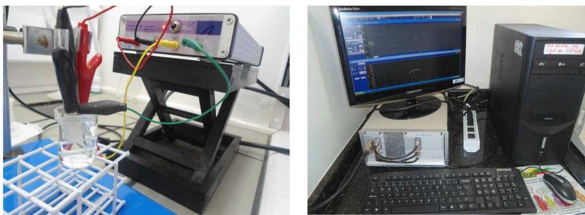
Figura 20: Potenciostato/Galvanostato Omnimetra Instrumentos utilizado para polimerização e caracterização (Foto do autor).
