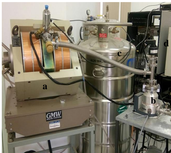
Figura 3.3. Sistema de medição onde foram realizadas as medidas de fotocondutividade, onde é possível observar o eletro-ímã (a), a bomba difusora de vácuo (b), o dewar de nitrogênio (c) e o sistema de controle de medição (d). Este sistema se encontra instalado no laboratório de caracterização eletro-óptica, da Universidade Federal de Itajubá.
