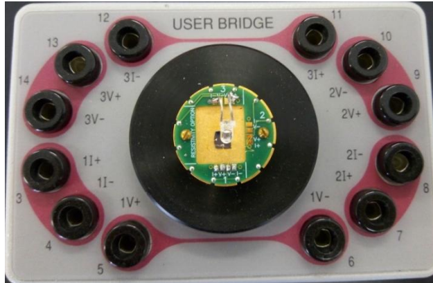
Figura3.5. Esquema de montagem dos filmes \text{Bi}_2\text{Te}_3 , no PPMS. Os contatos foram realizados com índio e a amostra é inserida no canal 2, do porta amostra. No canal 3, encontra-se montada um led de IR. Este porta amostra suporta 3 amostras .
