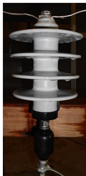
Fig. 5.13(b) - desligador eletromecânico conectado ao para-raios
