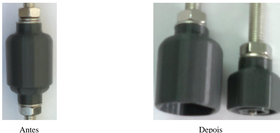
Fig. 5.7 - Desligador eletromecânico antes e depois da atuação.
