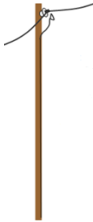
Fig. 2.1 - Para-raios desenvolvido na década de 1840 [4].
