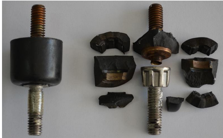
Fig. 4.2 - Fotografia de um desligador automático convencional antes e após a atuação.
