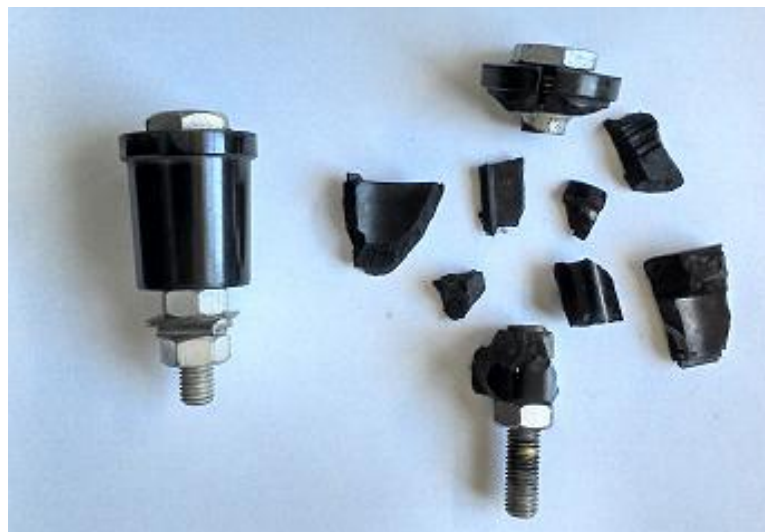
Fig. 4.1 - Fotografia de um desligador automático convencional antes e após a atuação.
