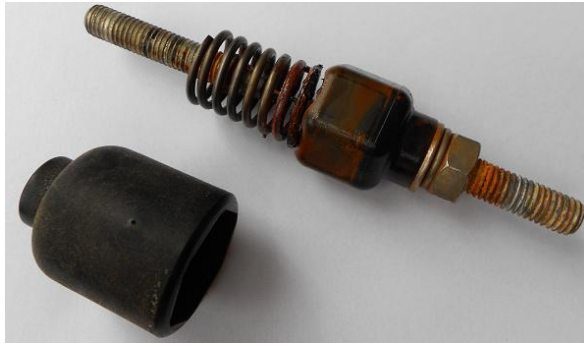
Fig. 5.14 (a) - desligador eletromecânico.
