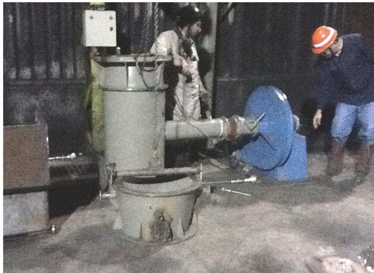
Figura 4.1 – Foto do equipamento de sinterização em bancada
