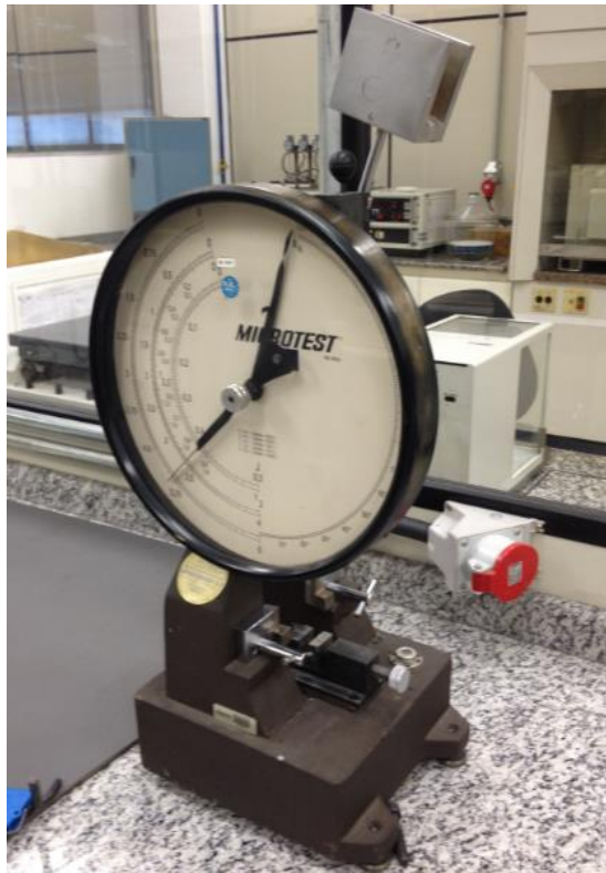
Figura 35: Máquina de ensaio de resistência ao impacto Izod Microtest 5102 – Laboratório da Plascar. Fonte: autor (2017).
