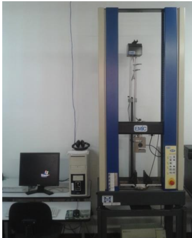
Figura 32: Máquina universal de ensaios mecânicos EMIC, modelo DL-3000 – Laboratório da UNIFEL. Fonte: autor (2017).
