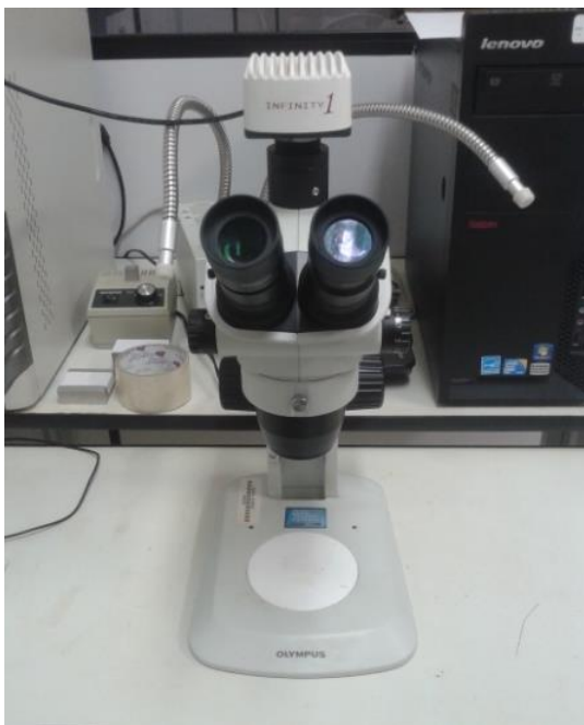
Figura 37: Estereoscópio Olympus – modelo SZ61 – Laboratório da UNIFEI Fonte: autor (2017).
