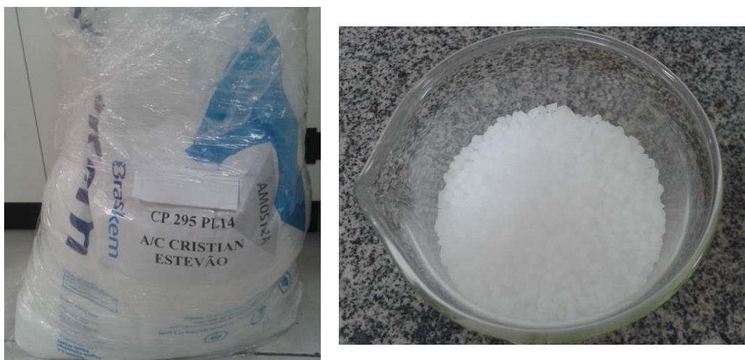
Figura 19: a) Polipropileno – copolímero de etileno virgem ( Grade : CP-295); b) Pellets de Polipropileno CP-295.
