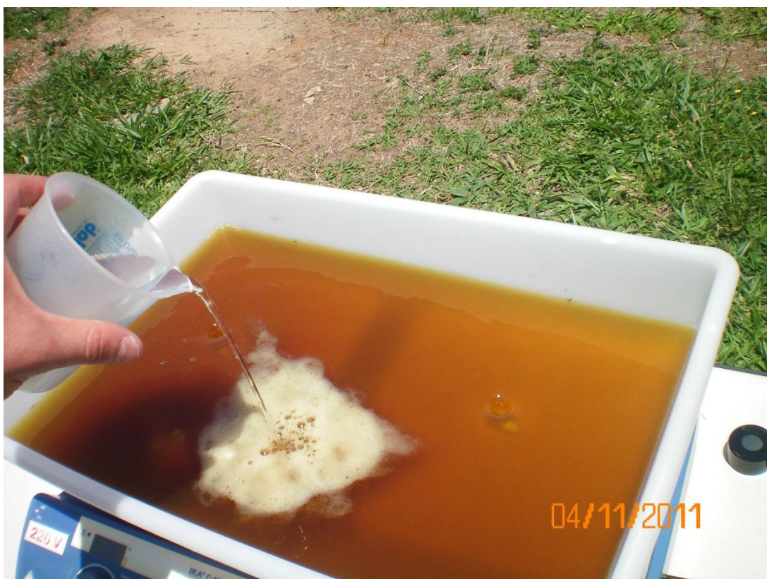
Figura 14: Reação de foto-Fenton no momento da adição de peróxido de hidrogênio
