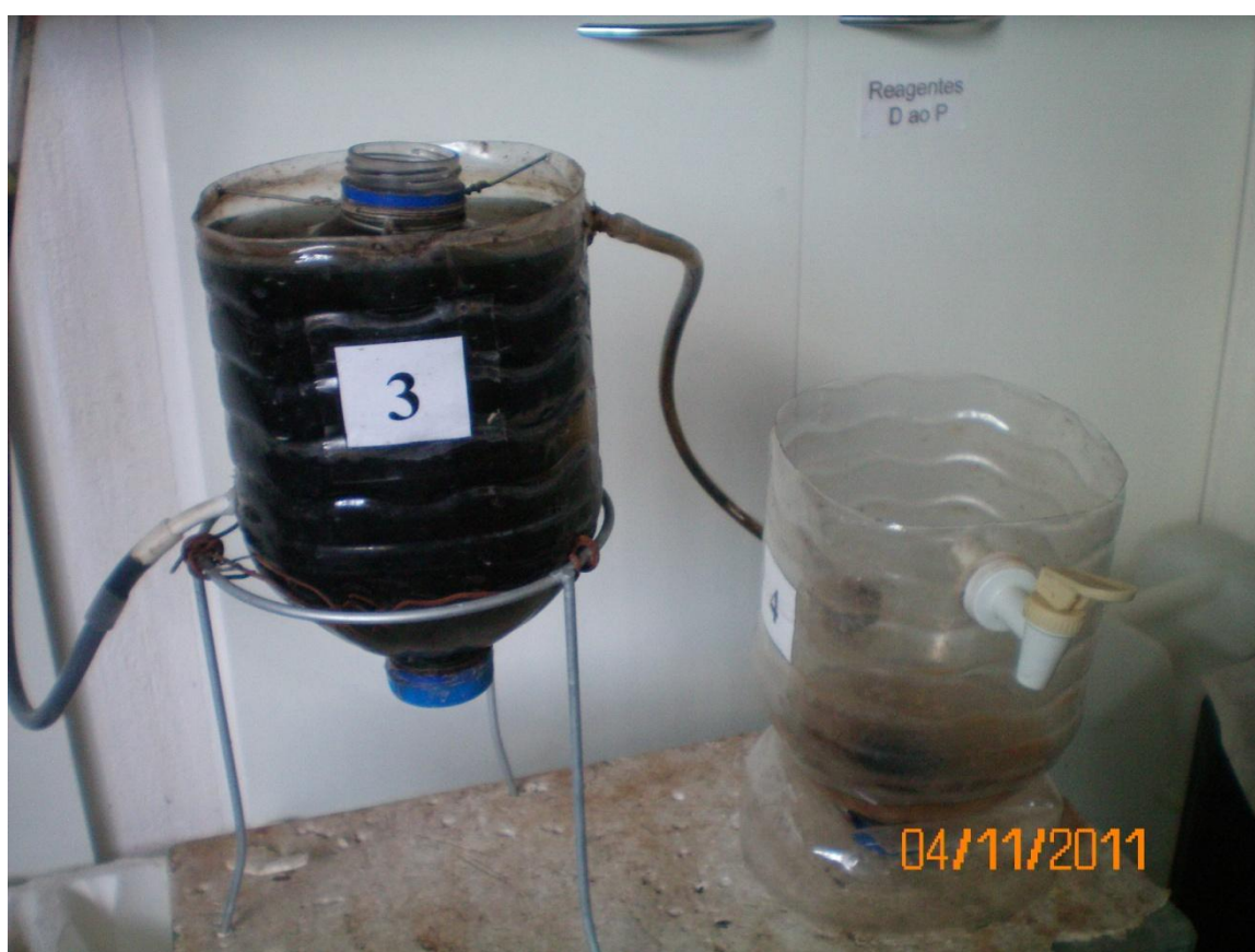
Figura 30: Câmara de digestão do UASB utilizado para o pós-tratamento da ARC
