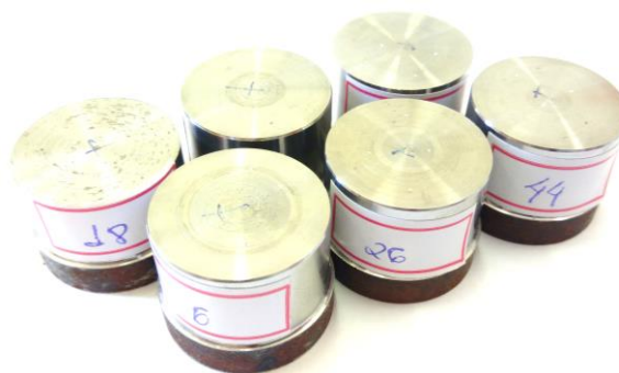
Figura 7.3. Corpos de prova de aço H13 endurecido
