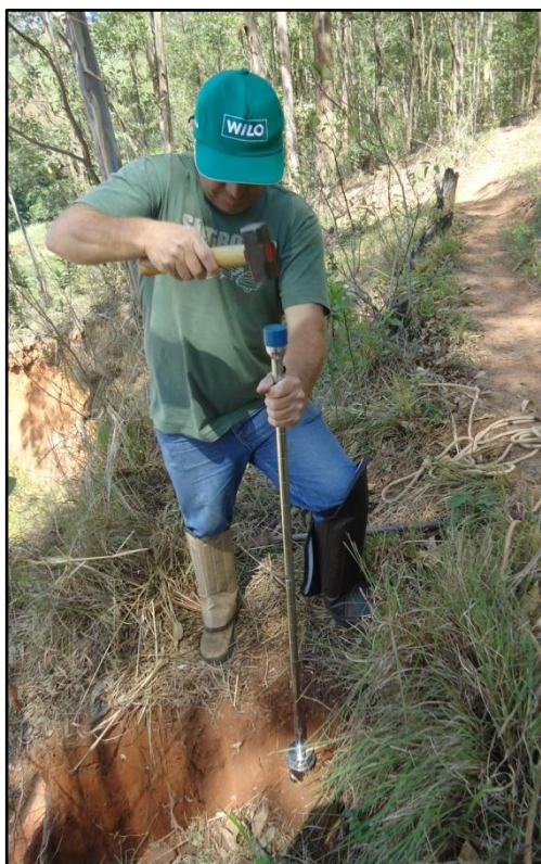
Figura 4.12: Procedimentos de coleta de amostras indeformadas de solo.
