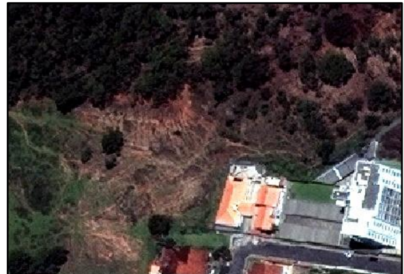
Figura 5.20: Deslocamento de massa em talude de corte, área degradada D19.
