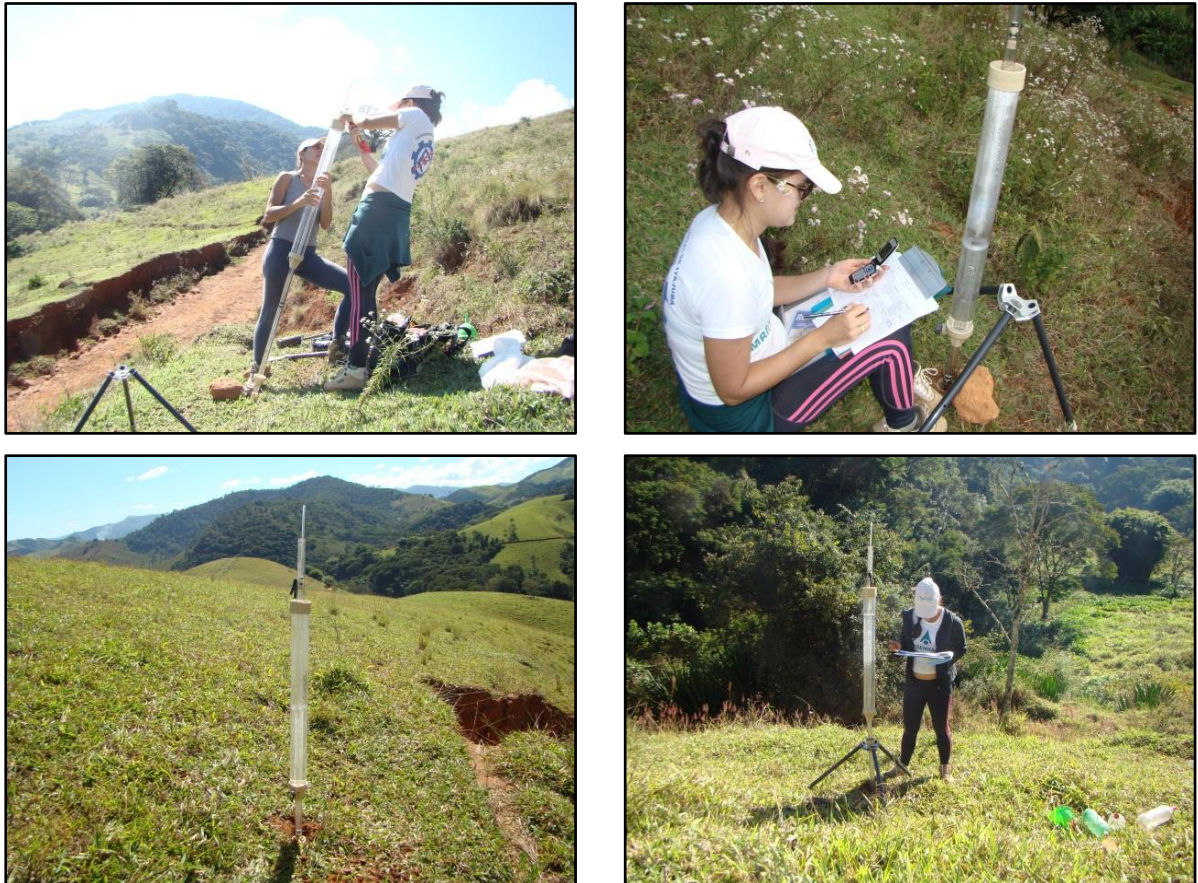
Figura 4.13: Ensaios realizados com o Permeâmetro de Guelph.
