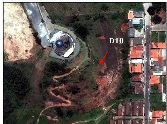
Figura 5.11: Deslocamento de massa em talude artificial, área degradada D10.
