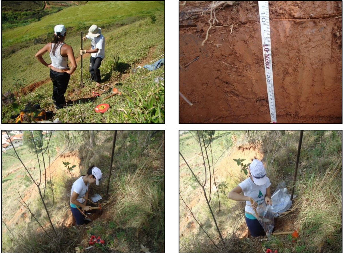
Figura 4.11: Procedimentos de coleta de amostras deformadas de solo.
