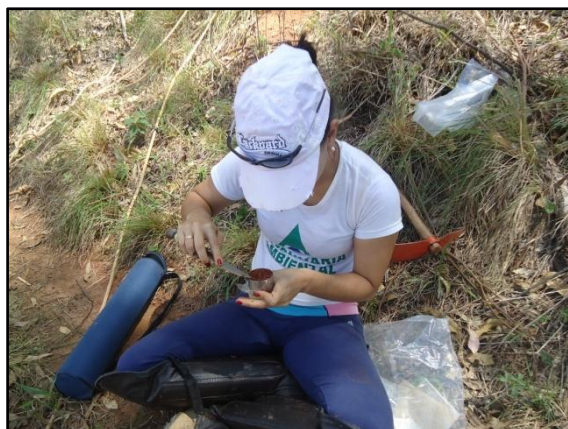
Figura 4.12: Procedimentos de coleta de amostras indeformadas de solo.
