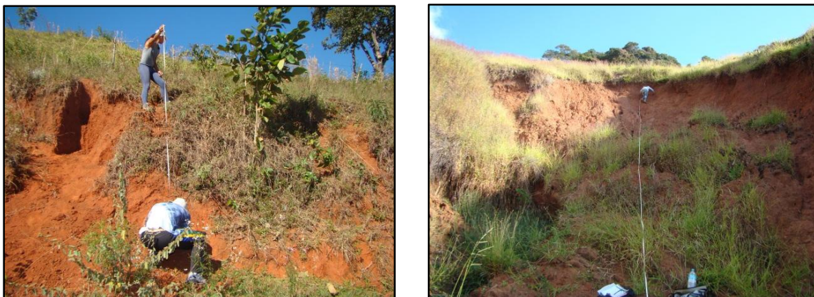
Figura 4.10: Mensuração das áreas degradadas, realizada com trena ou régua graduada, durante a etapa de caracterização.
