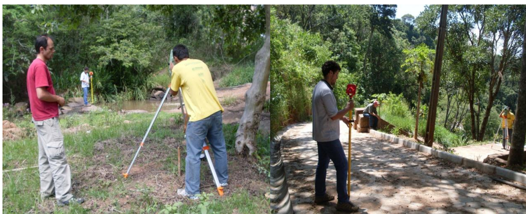
Figura 4.1- Medições Topográficas para determinação da queda bruta A Figura 4.2 ilustra uma central de desvio apresentando suas alturas de quedas.
