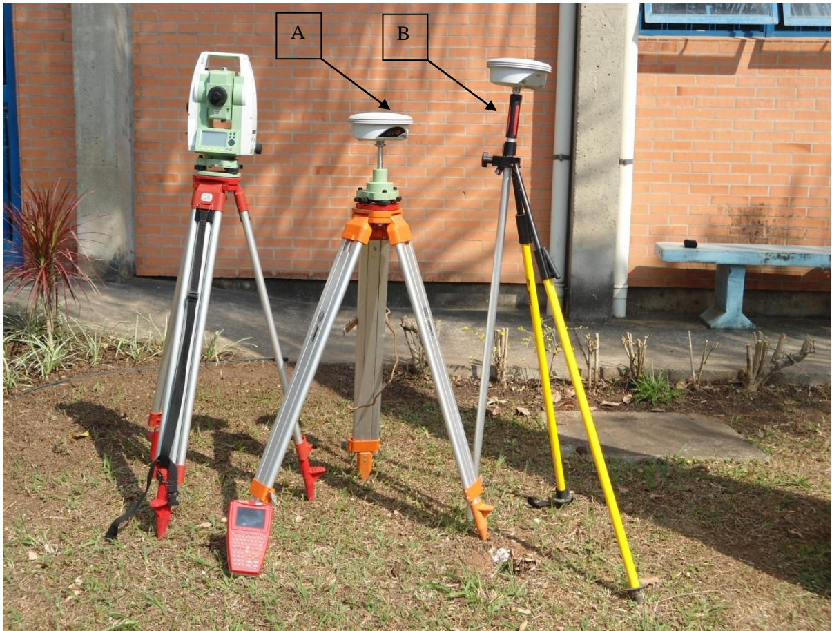
Estação total e DGPS (A e B – base e móvel). (Fonte: autor)
