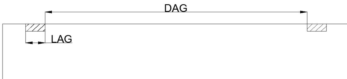
Figura 14 - Vista em Corte do Anel de Guarda Construído com Dopante tipo P+.
