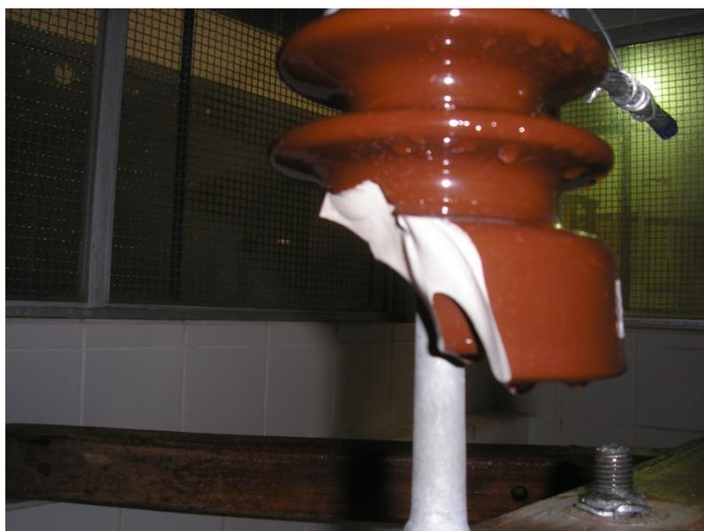
**Figura 30 - Isolador tipo pino partido após ensaio
