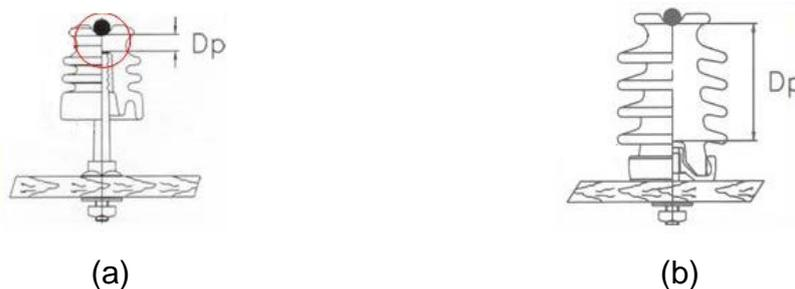
Figura 26 - Distância de isolamento (a) tipo pino e (b) tipo pilar.
