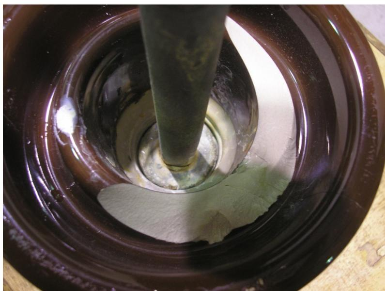
Figura 32 - Isolador tipo pino partido após ensaio (250  $\mu$ S/cm; 2 mm/min; 15 min).
