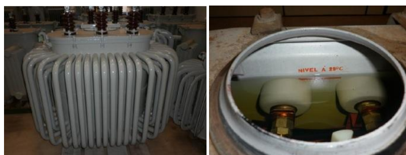
Figura 2.2- (a) Transformador de distribuição. (b) Tanque contendo núcleo ativo imerso no fluído isolante
