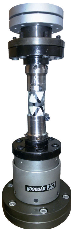
3.18 – Montagem dos suportes e do tubo de travessas rígidas para o ensaio de torção.
