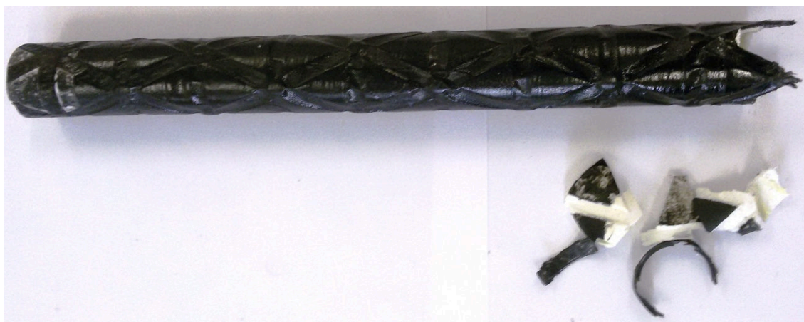
4.18 – Análise da falha no Tubo 3 da estrutura CF26. Fonte: Autor
