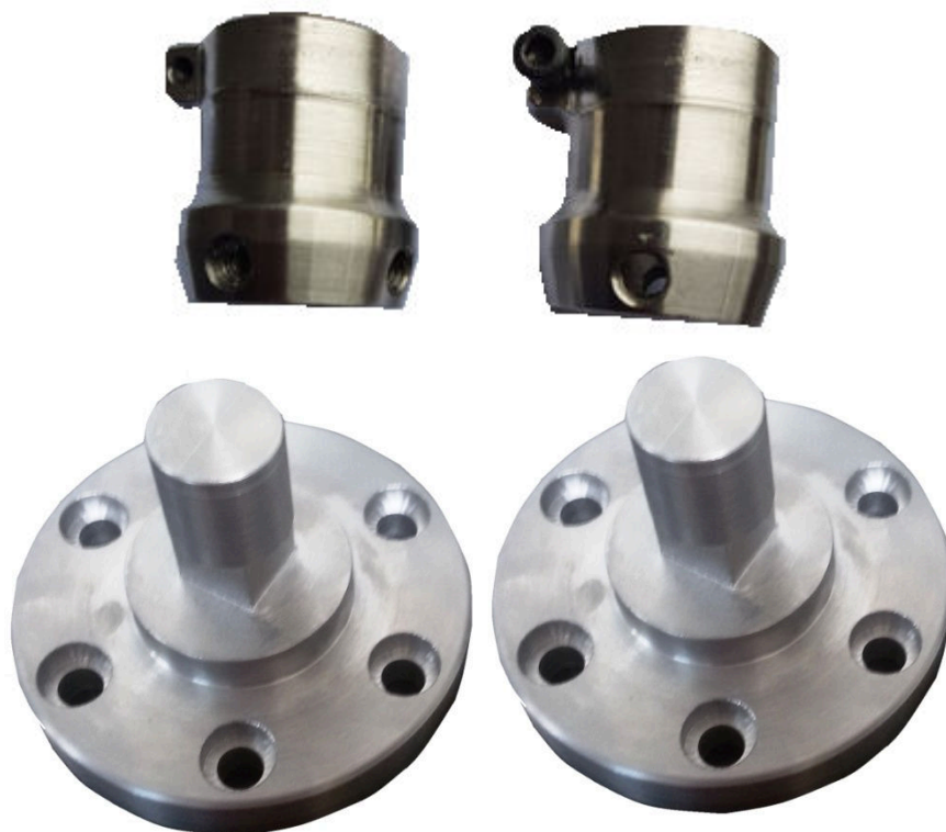
3.17 - Dispositivos de ensaio de compressão e torção. Fonte: Autor
