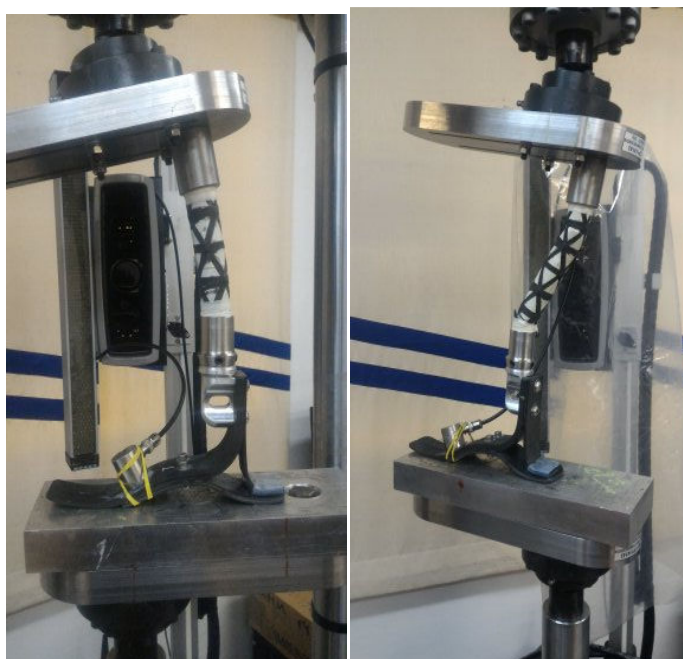
4.26 - Falha dos tubos no pé e calcanhar, respectivamente. Fonte: Autor
