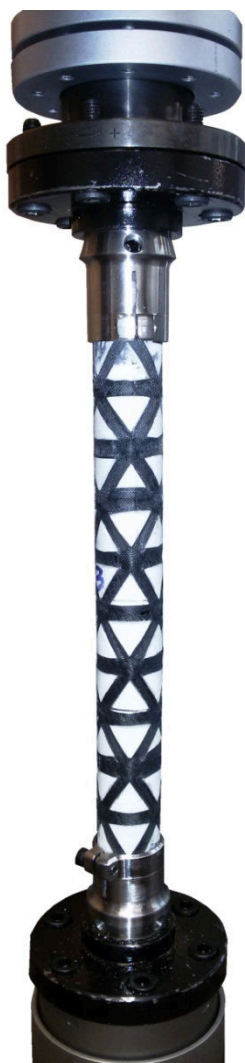
3.19 - Montagem dos suportes de ensaio e do tubo de travessas rígidas na máquina de ensaio universal para o ensaio de compressão. Fonte: Autor
