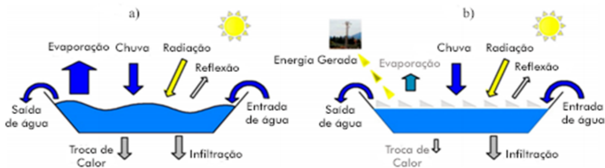
Figura 2.2 – Balanço hidro-energético: a) reservatórios sem USF e b) com USF
