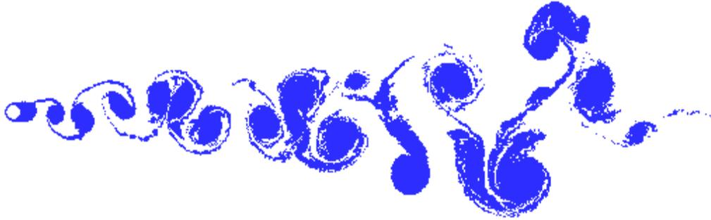
Figura 5.2 – Esteira de vórtices discretos utilizada no estudo estatístico realizado para determinar a espessura da coroa circular (Euler;  $mb1 = 300$ ;  $\Delta t = 0,05$ ;  $\sigma_0 = \text{eps} = 0,001$ ;
