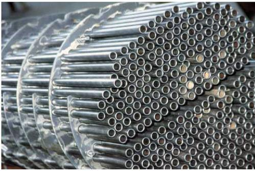
(a) Trocador de calor do tipo casco e tubos
