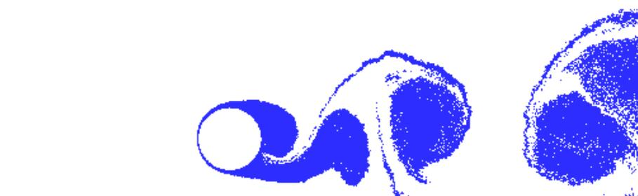
Figura 5.24 – Posição dos vórtices discretos na esteira no instante representado pelo ponto A da Figura 5.21b (Euler;  $mb1 = 300$ ;  $mb2 = 950$ ;  $\Delta t = 0,05$ ;  $sm = 3,0$ ;  $\varepsilon = 0,000$ ;  $h = 0,45$ ;  $Re = 1,0 \times 10^5$ ).
