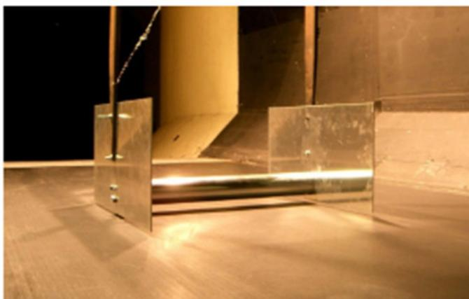
Figura 2.8 – Placas utilizadas nas extremidades do cilindro circular para tornar o escoamento aproximadamente bidimensional (Nishino, 2007).
