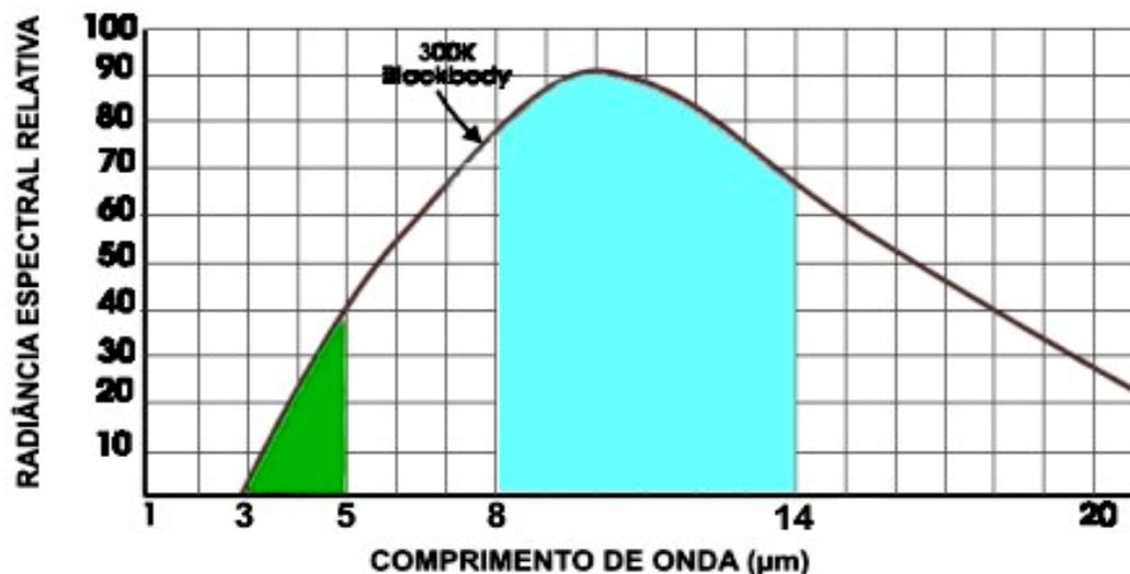
Figura 3.1 – Energia disponível nas faixas de 3 a 5  $\mu\text{m}$  e de 8 a 14  $\mu\text{m}$  para um Corpo Negro a uma temperatura de 300 K (26,8  $^{\circ}\text{C}$ ) (Kaplan, 2000).
