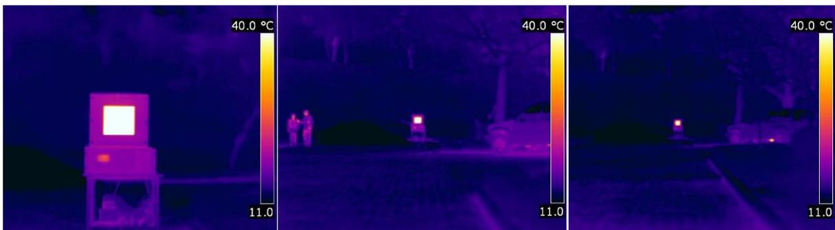
Figura 4.18 – Termogramas do ensaio com nevoeiro.
