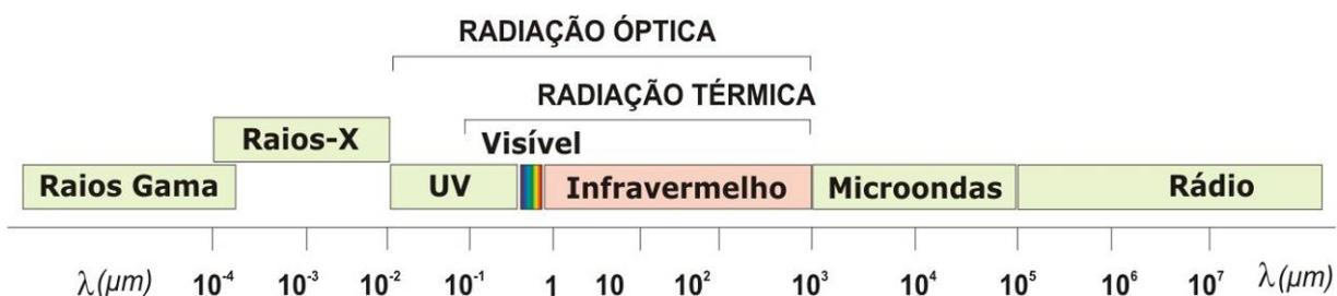
Figura 2.2 – Espectro eletromagnético (Santos, 2006).
