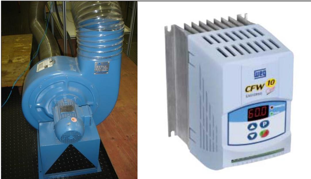
Figura 4.26 – Soprador axial à esquerda e Inversor de frequência à direita.
