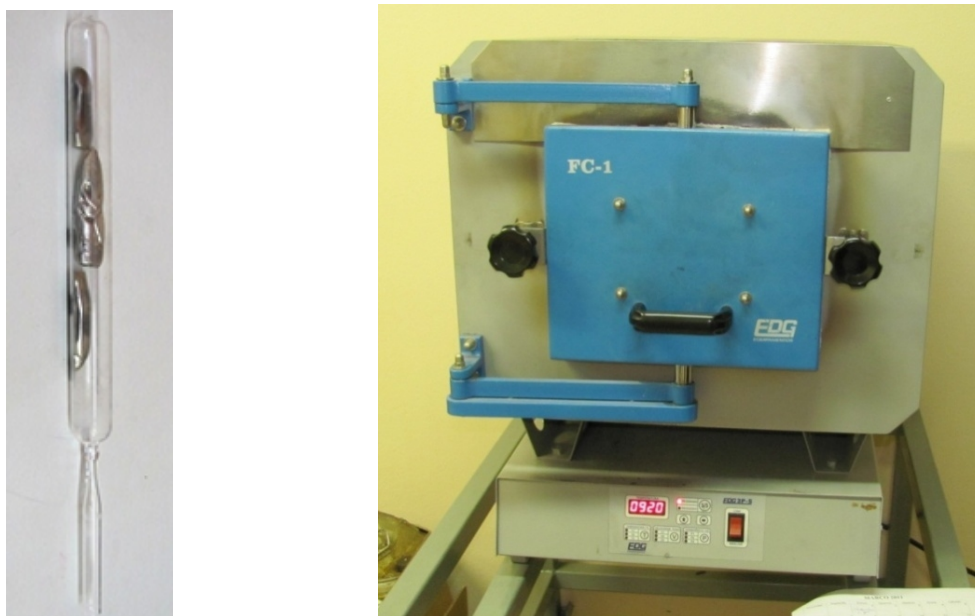
Figura 3.4 Amostras encapsuladas a vácuo e forno utilizado para homogeneização. (Laboratório de Metalurgia Física e Solidificação UNICAMP).
