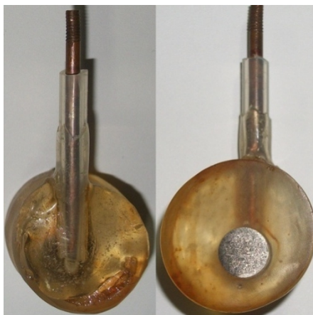
Figura 3.10 Amostra embutida para ensaio de corrosão
