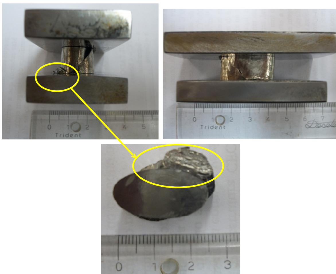
Figura 4.8 Corpo de prova da amostra 4C deformada a frio, sem controle de velocidade.
