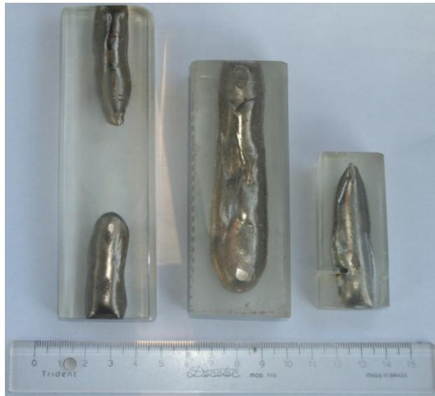
Figura 3.5 Amostras embutidas para serem cortadas.
