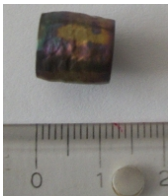
Figura 4.12 Aspecto característico de uma amostra submetida à deformação a quente.
