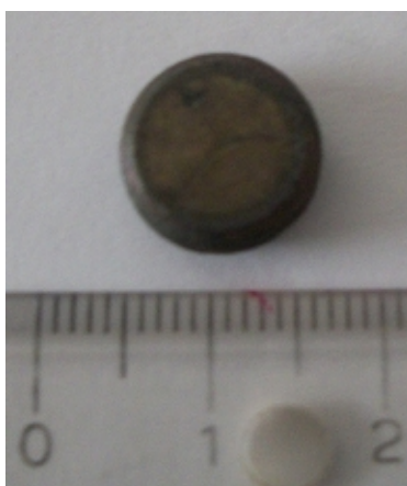
Figura 4.13 Aspecto da amostra 1B com 50% de deformação.
