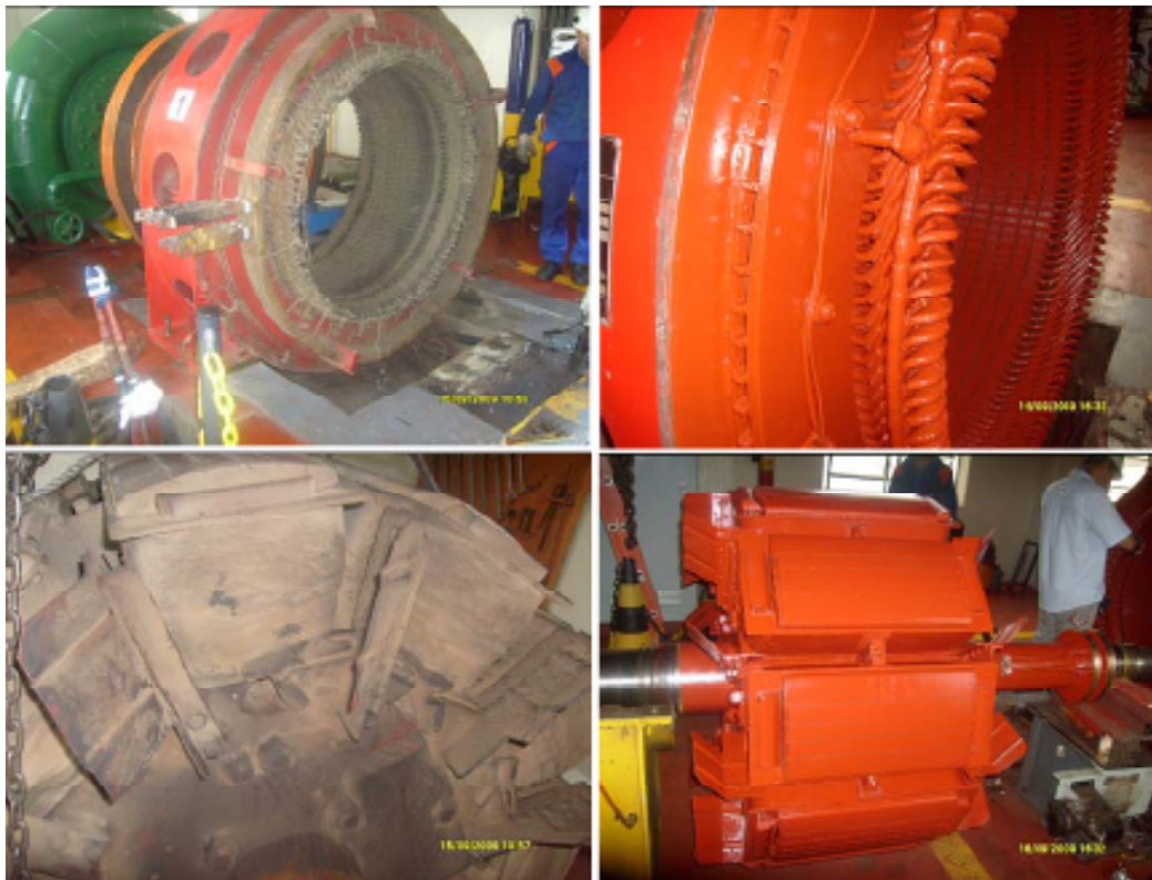
Figura 29: Bobinado estatórico e rotórico do gerador, antes e depois da limpeza e pintura.
