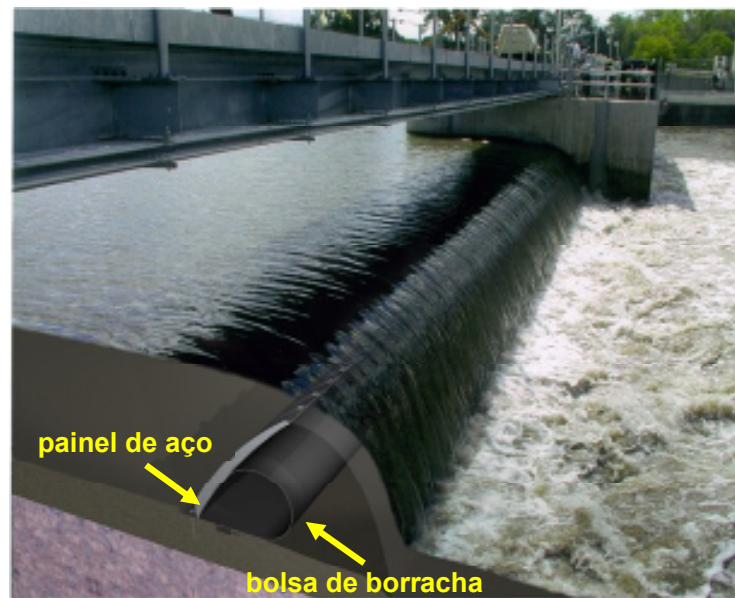
Figura 18: Vista esquemática de uma comporta inflável com placas de aço
