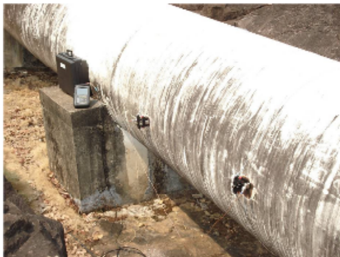
Figura 49: Esquema de instalação dos sensores de vazão ultra-sônico
