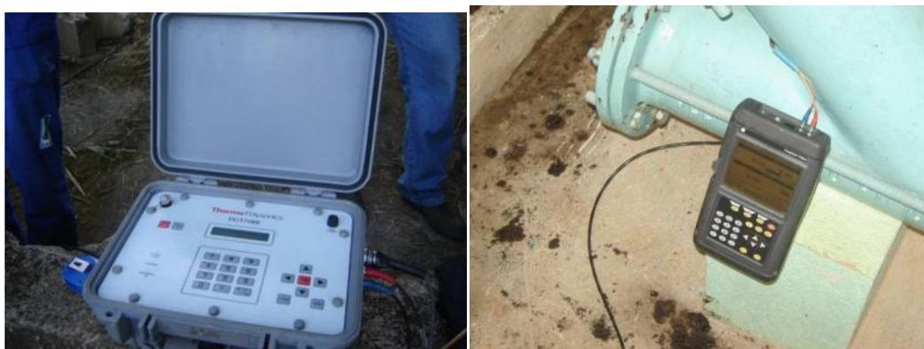
Figura 8.6. Medidores de vazão ultrassônicos Thermo Polysonics e GE.
