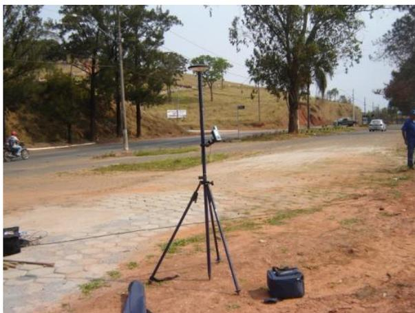
Figura 8.10. DGPS para obtenção do desnível geométrico.
