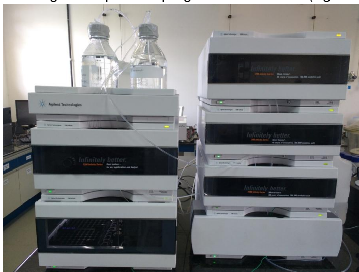
Figura 11 - Cromatógrafo Líquido empregado nas análises (Agilent 1260 Infinity)
