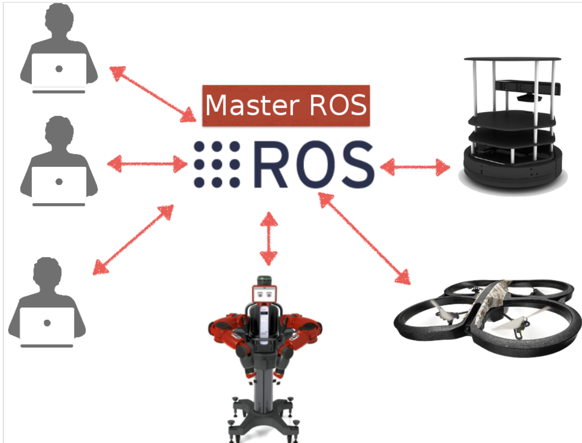
Figura 2.7.3 – Abordagem centralizada do ROS. Um ou mais usuários se conectam a um ou mais robôs por meio de um único Master . Fonte: Adaptado de (KOUBAA et al. , 2017).
