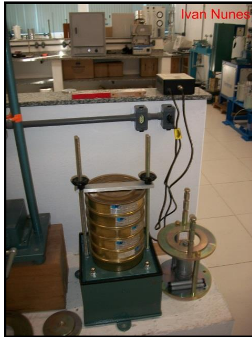
Figura 10 - Peneirador utilizado para separar as frações granulométricas pré – estabelecidas por Fonseca e Rocha (2004).
