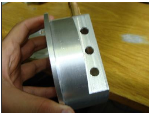
Figura 16 – Vista lateral, observa-se três furos para conectores BNC.
