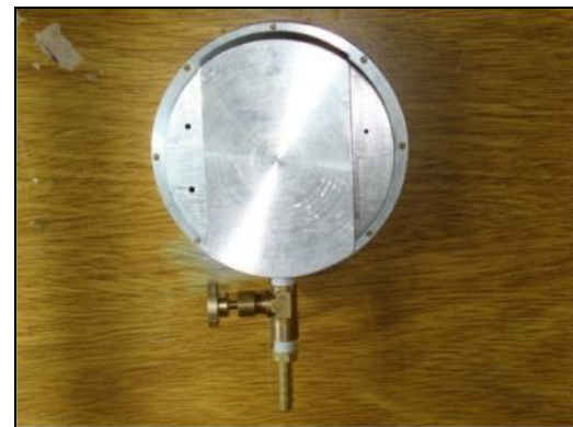
Figura 17 – Vista de trás do criostato. Do lado esquerdo os dois furos para os fios da resistência elétrica, do lado direito o furo para o termopar.
