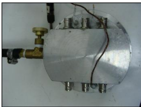
Figura 20 – Vista de trás dos seis conectores BNC.
