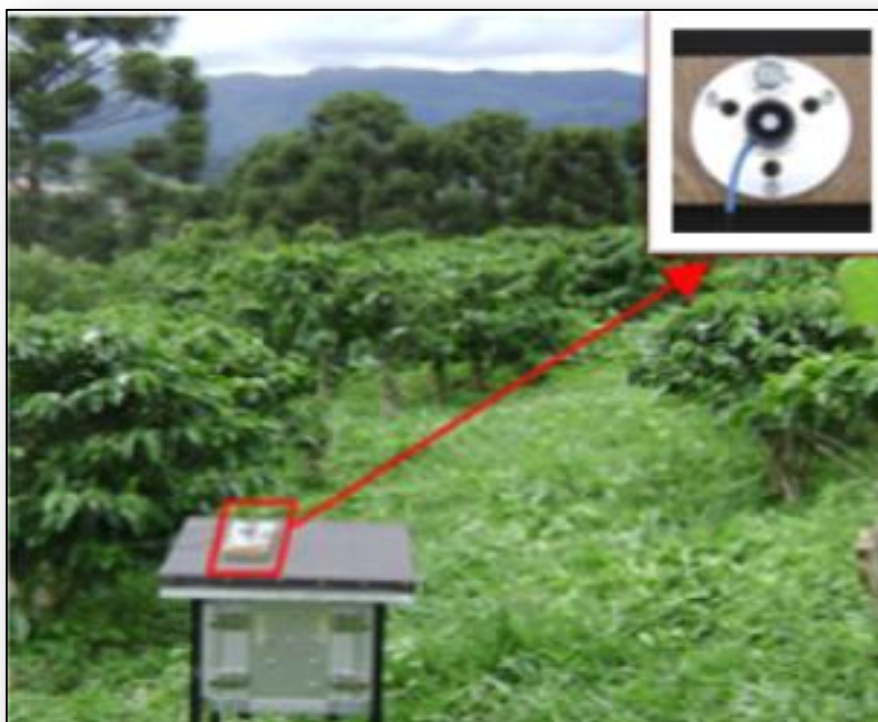
Figura 8 –Sensor LI-190 posicionado sem interferência de sombreamento.
