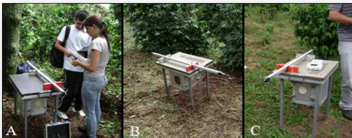
Figura 7 – Sensor LI-191 nos diferentes níveis de sombreamento: A = café com sombreamento intenso; B = café com sombreamento médio; C = café a sol pleno.
