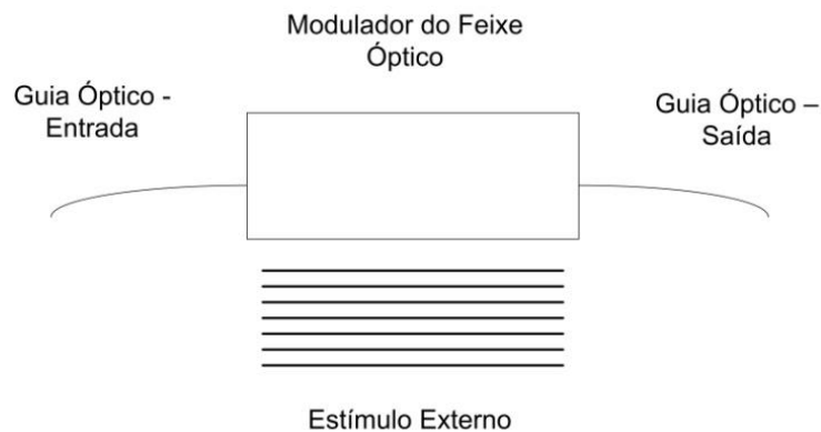
Figura 3.4 – Sensor em FO extrínseco: transdutor óptico acoplado ao guia óptico. Traduzida do trabalho de YIN et al. (2008).
