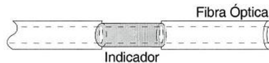
Figura 3.10 – Sensor óptico baseado no decaimento fluorescente utilizando configuração evanescente (CALDAS, 2003).
