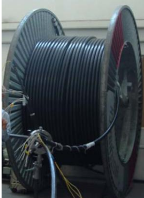
Figura 3.46 – Implementação de um sistema de monitoramento de temperatura para cabos isolados (INAUDI e GLISIC, 2006).
