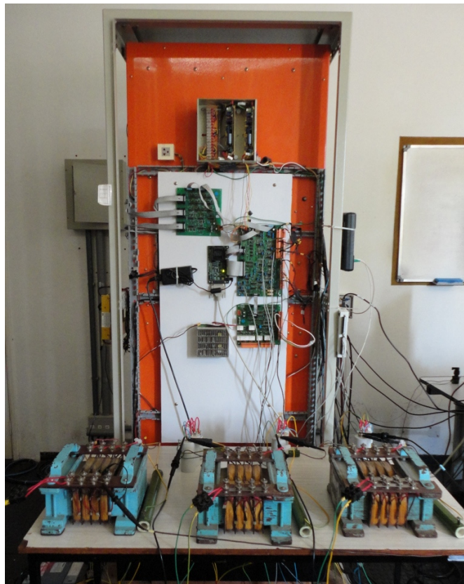
Figura 7.1 - Visão Geral do Protótipo do Compensador Híbrido de Reativo
