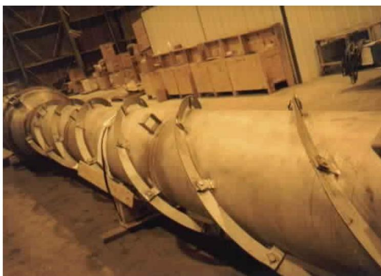
Figura 2.14 – Montagem de *Strakes* para minimizar o efeito de sincronização das forças fluidas ao longo do comprimento de uma estrutura cilíndrica. (Fonte: <http://www>).
