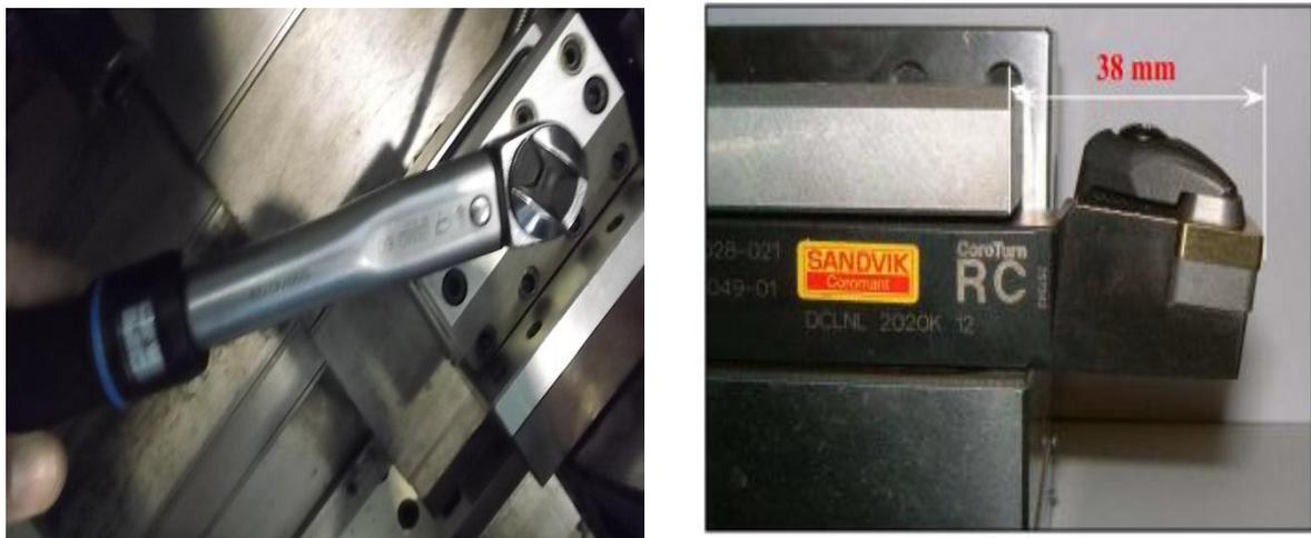
Figura 4.11 – Colocação do porta ferramenta no dinamômetro piezoelétrico.
