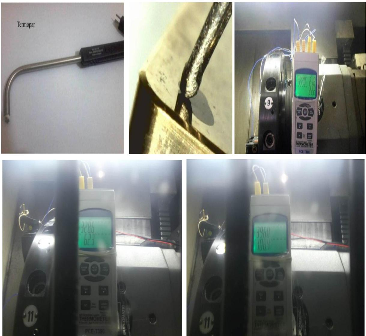
Figura. 4.15 – Esquema do aparato experimental termopar ferramenta.
