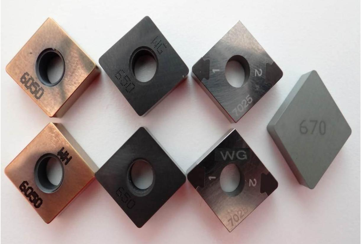
Figura 4.2 – Ferramentas utilizadas nos experimentos: CC6050, CC6050 WH, CC650 WG, CC650, PCBN7025, PCBN7025WG, CC 670.
