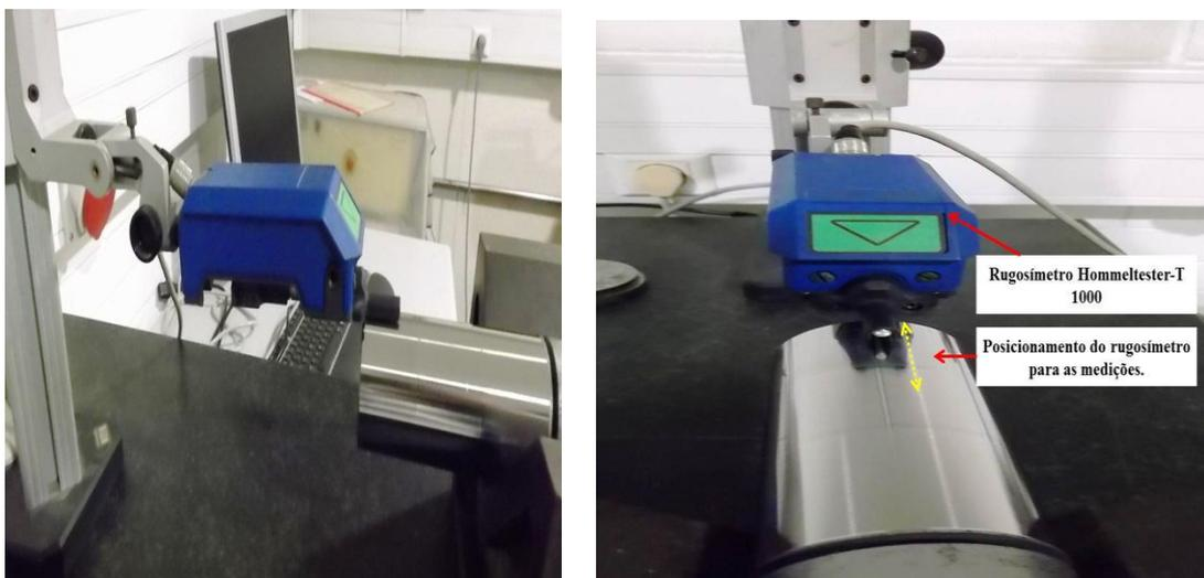
Figura 4.8 – Posicionamento do rugosímetro para as medições.
