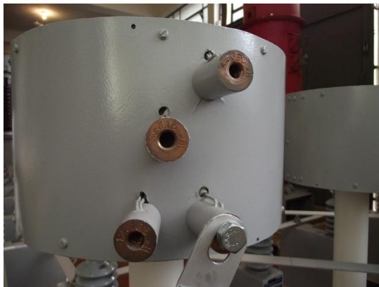
Figura 2.21 - Taps de indutor utilizado em um dos elementos \pi .
