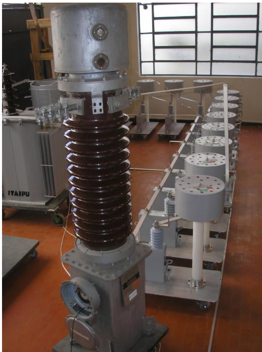
Figura 2.18 - TC 1 conectado no início da linha de transmissão.
