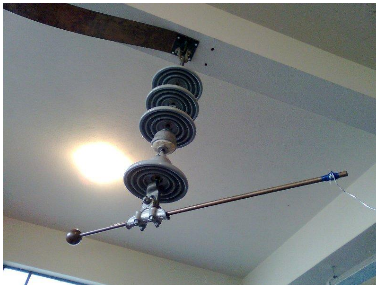
Figura 5.3 - Cadeia de isoladores de porcelana com um dos isoladores quebrado.
