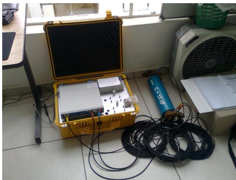
Figura 2.9 - Primeiro ensaio com o Franalyzer ® : ensaio de resposta em frequência em um capacitor conhecido.
