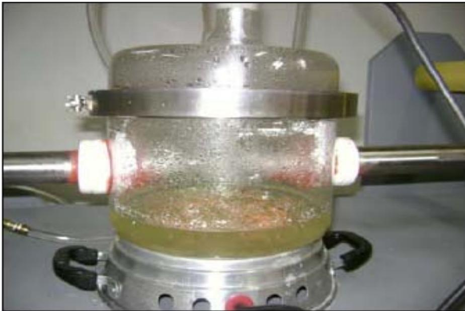
Figura 3.11 - Processo de vedação da cuba para os ensaios de corrosão sob tensão.
