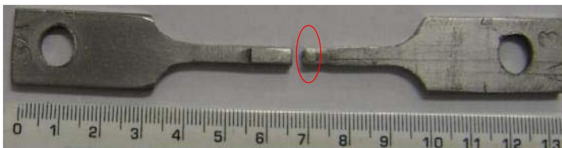
Figura 4.31 (a) - Corpo de prova sem CST
