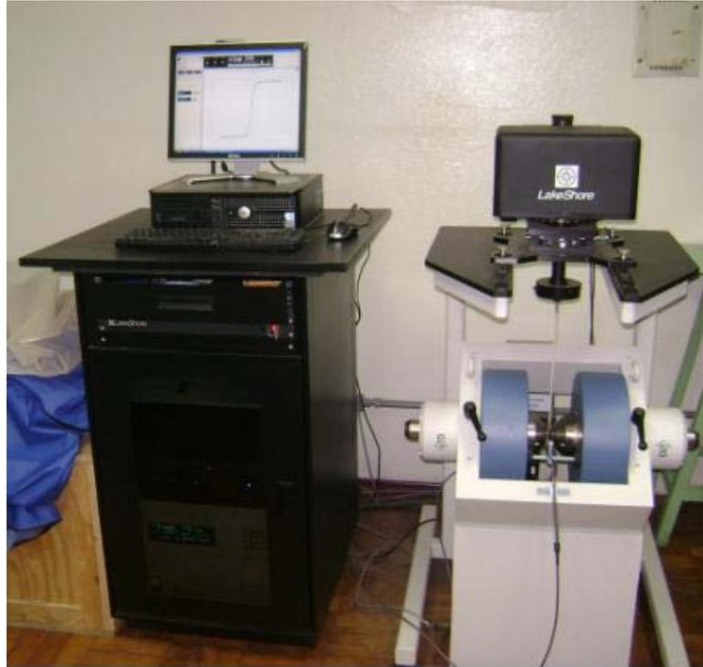
Figura 3.13 - Magnetômetro de Amostra Vibrante marca Lake Shore, modelo VSM. Fonte: Laboratório de Ensaios Destrutivos, UNIFEL.
