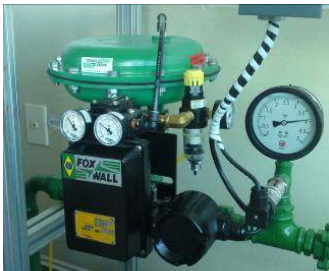
Figura 6 – Válvula de controle de vazão
