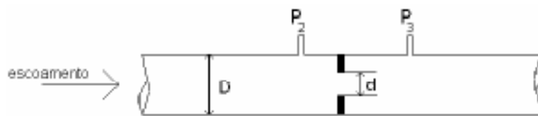
Figura 8 – Desenho esquemático da placa de orifício
