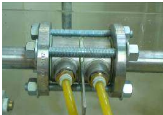
Figura 5 – Placa de orificios
