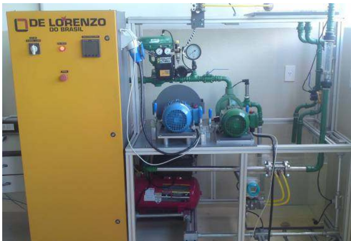
Figura 16 – Bancada de ensaio de motores elétricos
