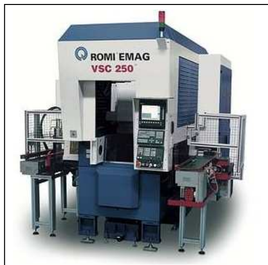
Figura 2.1- Centro de Torneamento Vertical Romi Emag VSC 250
