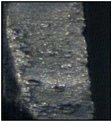
(a) Desgaste de flanco
