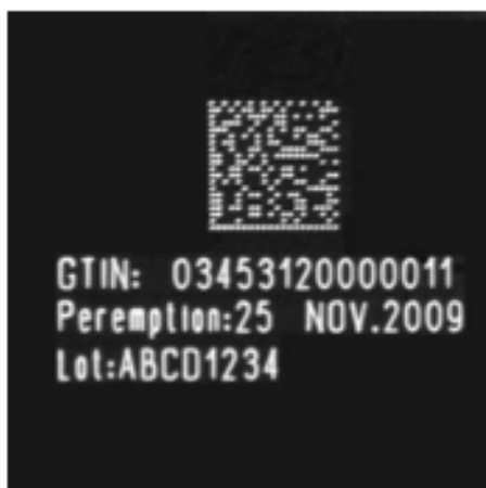
Figura 13: Exemplo de GS1 DataMatrix impresso usando Laser. Fonte: GS1 Brasil, 2009
