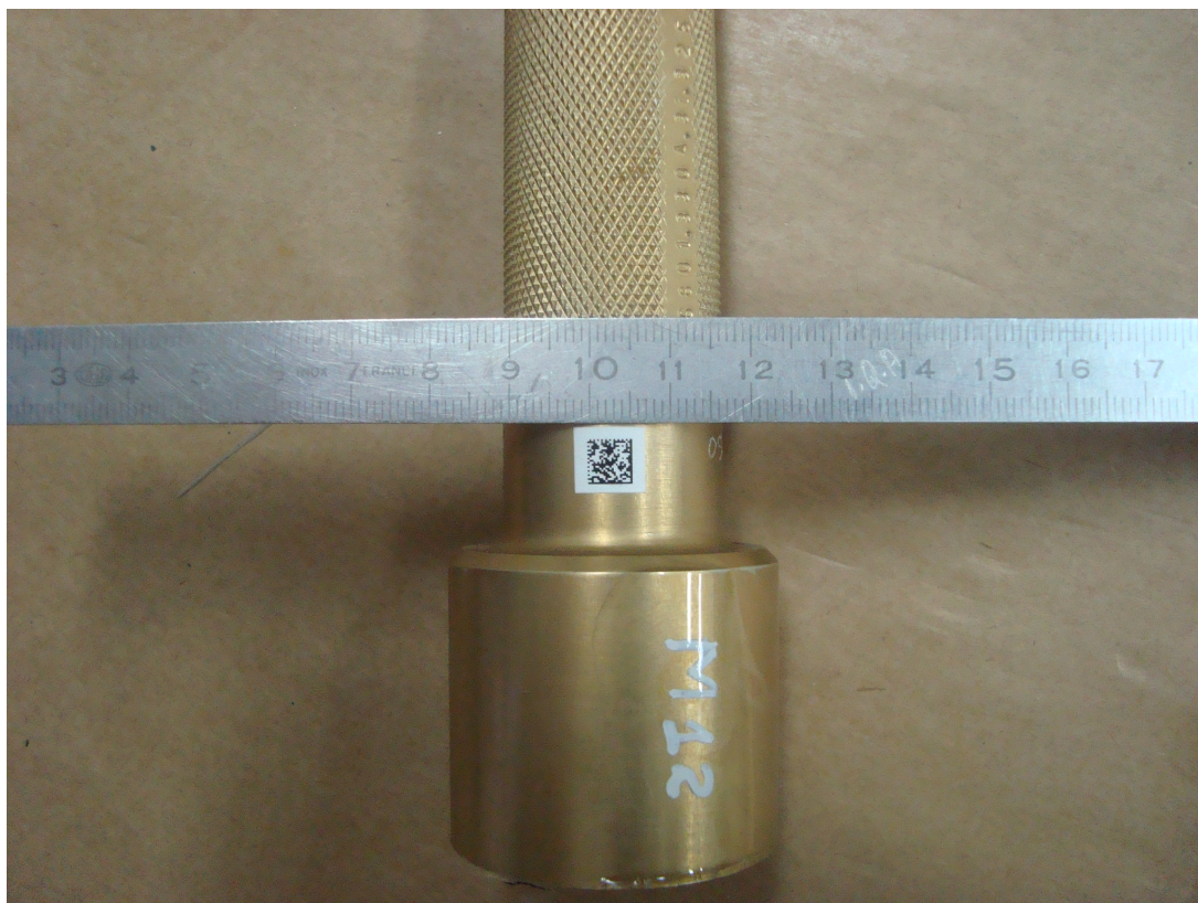
Figura 41: Segundo ferramental identificado com o código GS1 DataMatrix , em superfície curva.
