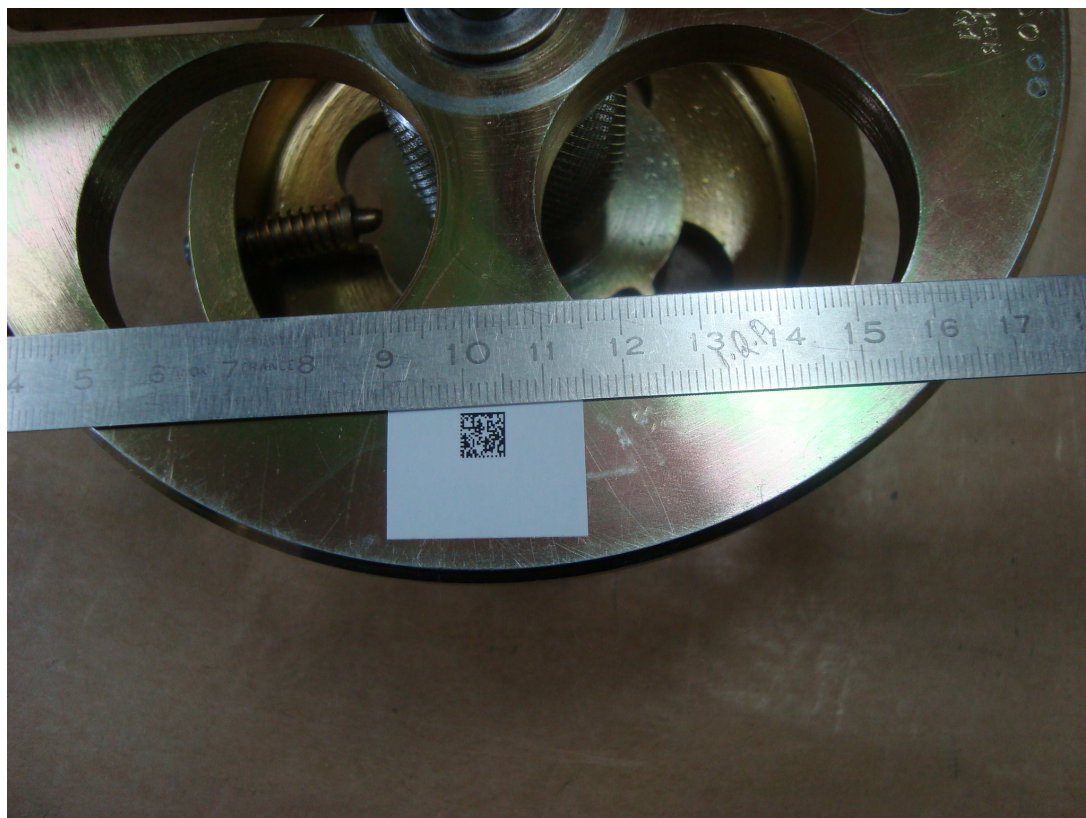
Figura 39: Primeiro ferramental identificado com o código GS1 DataMatrix , em superfície plana.
