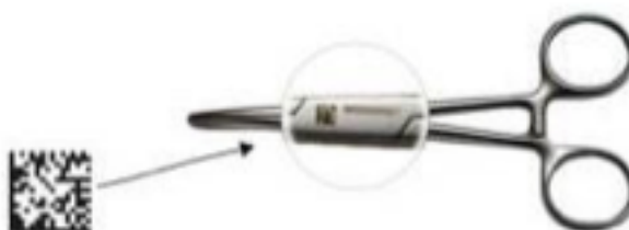
Figura 14: Exemplo de marcação direta por punção (GS1 DataMatrix ). Fonte: GS1 BRASIL, 2009
