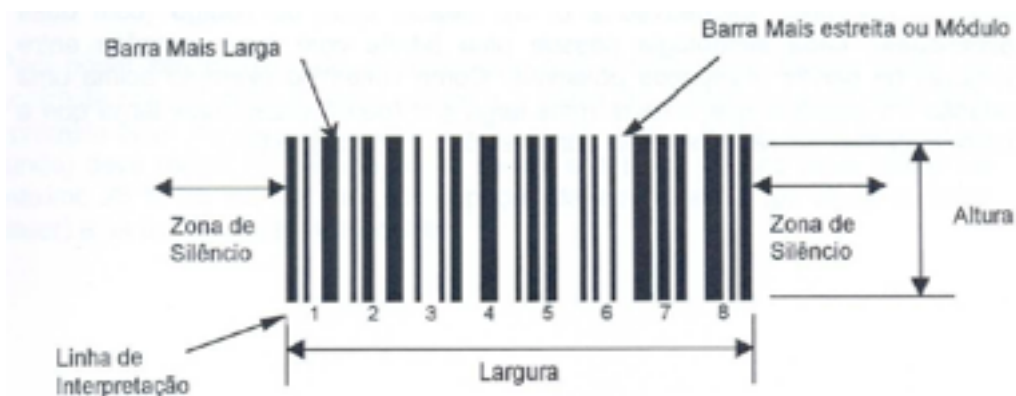
Figura 10: Estrutura do Código de Barras Linear. Fonte: Albareda et al., 2007.
