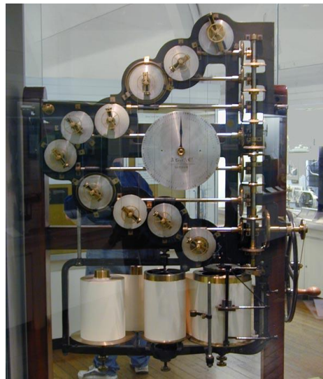
Figura 14. Máquina de predição de 10 componentes de maré concebida por William Thomson (Lord Kelvin) do Museu de Ciência de Londres (Science Museum, South Kensington). Disponível em: < http://en.wikipedia.org/wiki/Tide-predicting_machine >, Acesso em 30/07/ 2010.
