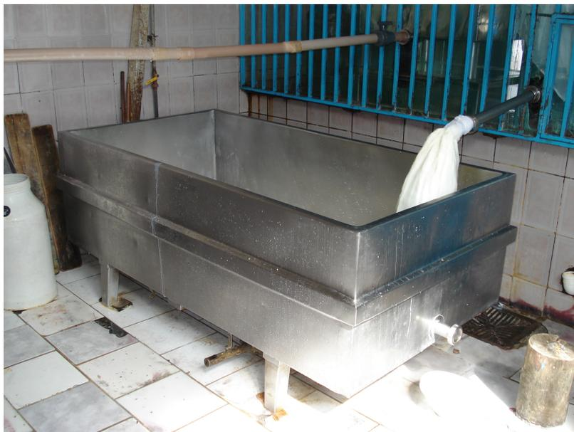
**FIGURA 10.** Tanque de 1.000 L para coagulação do leite.
