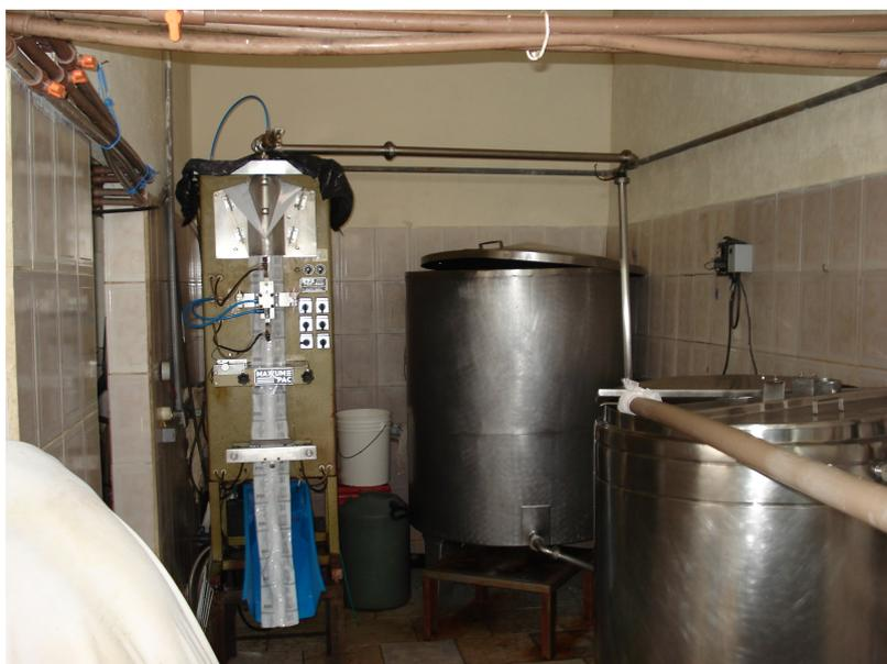
**FIGURA 11.** Em detalhe no setor 3, à frente, o tanque de pasteurização, ao fundo a direita, o tanque de armazenamento, e, ao fundo a esquerda, a empacotadora.
