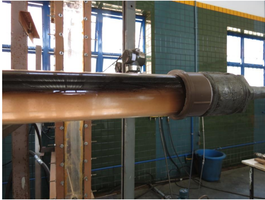
Figura 6.1 – Bancada experimental no laboratório Núcleo de Separadores Compactos na UNIFEI para a separação de óleo e água.
