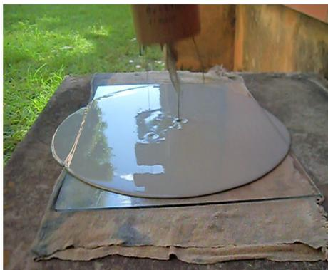
Figura 5.5: Abatimento da amostra 2. Dosagem de 0,857% do aditivo 1 e 0,857% do aditivo 2.
