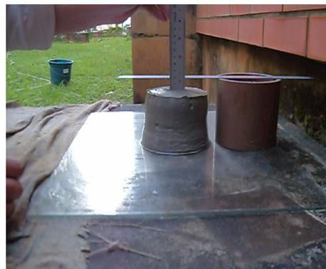
Figura 5.6: Abatimento da amostra 3. Dosagem de 0,286% do aditivo 1 e 2,64% do aditivo 2.
