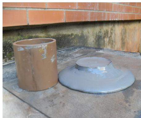
Figura 5.4: Abatimento da amostra 1. Dosagem de 0,286% do aditivo 1 e 0,857% do aditivo 2.
