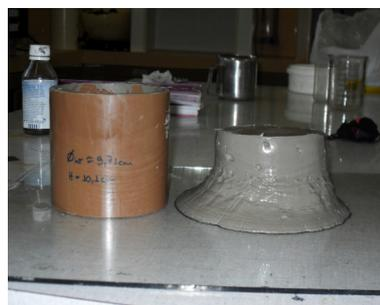
Figura 5.11: Abatimento da amostra 8. Dosagem de 0,57% do aditivo 1 e 3% do aditivo 2.
