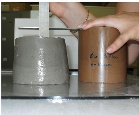
Figura 5.3: Abatimento da amostra 0 (controle) sem aditivos.
