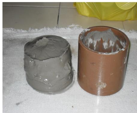
Figura 5.8: Abatimento da amostra 5. Dosagem de 0,143% do aditivo 1 e 1,75% do aditivo 2
