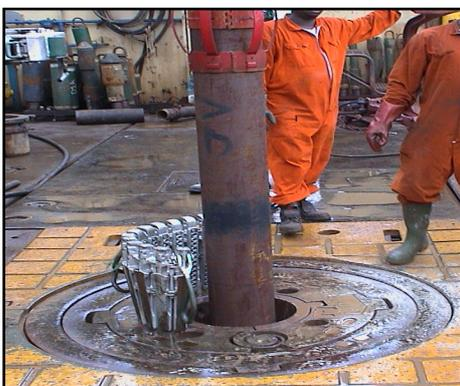
Figura 2.5: revestimento de poço de petróleo [51]
