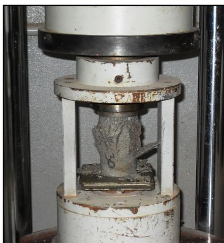
Figura 4.17: Ensaio de rompimento à compressão dos corpos de prova.
