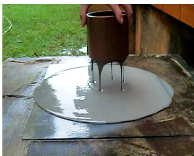
Figura 5.10: Abatimento da amostra 7. Dosagem de 0,57% do aditivo 1 e 0,5% do aditivo 2.
