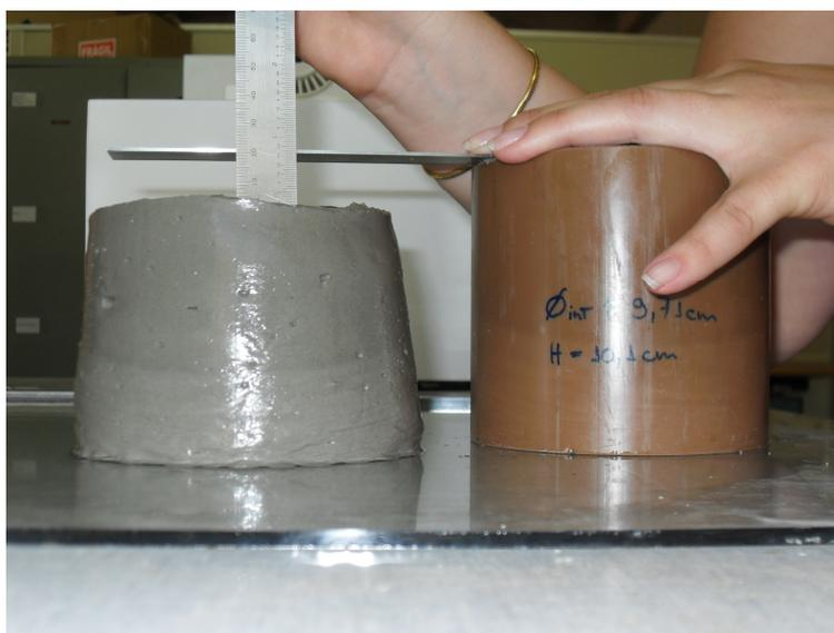
Figura 4.12: ensaio de abatimento modificado na pasta de cimento.
