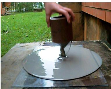
Figura 5.9: Abatimento da amostra 6. Dosagem de 1% do aditivo 1 e 1,75% do aditivo 2.
