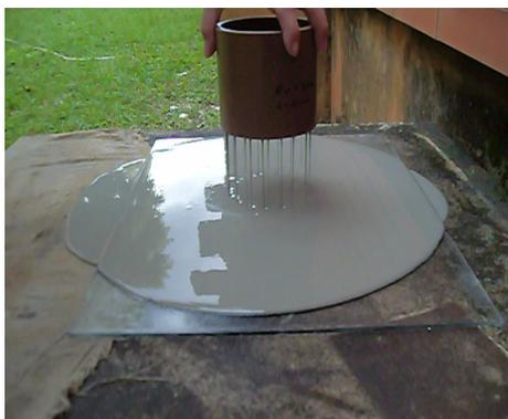
Figura 5.7: Abatimento da amostra 4. Dosagem de 0,86% do aditivo 1 e 2,64% do aditivo 2.
