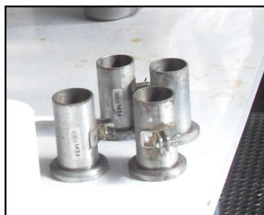
Figura 4.14: Moldes cilíndricos.
