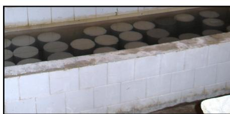
Figura 4.16: Tanque de cura.
