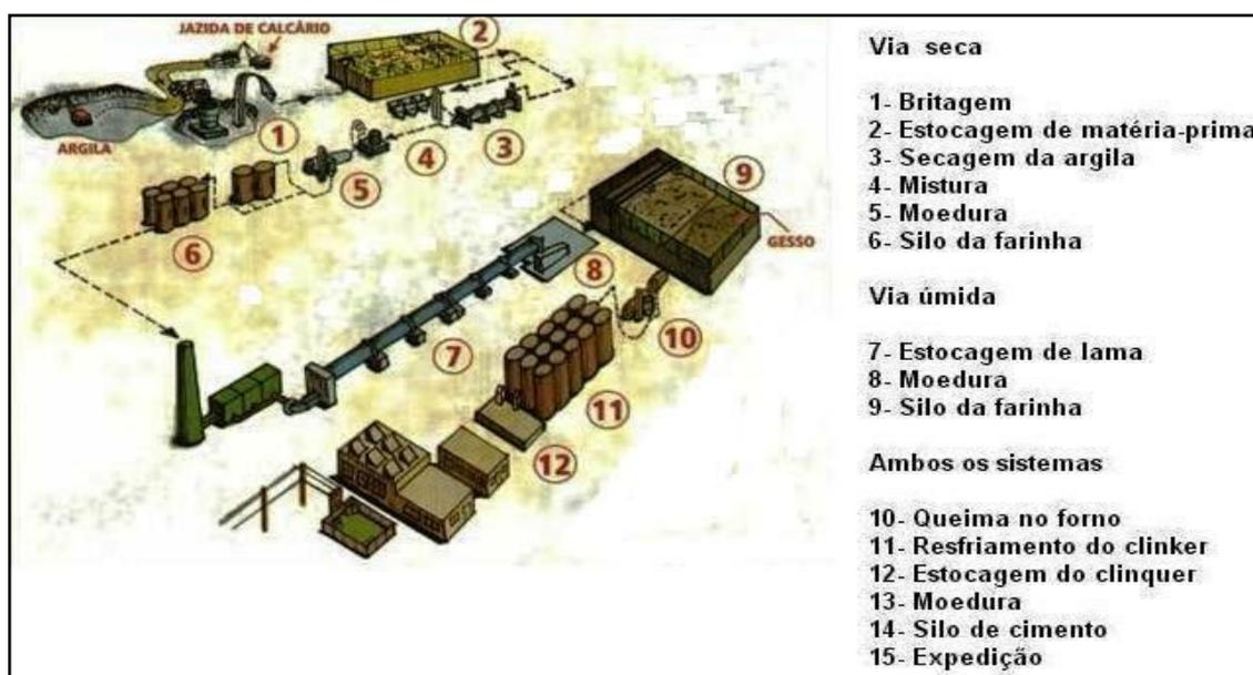
Figura 2.1: Processo de fabricação do cimento Portland [4].
