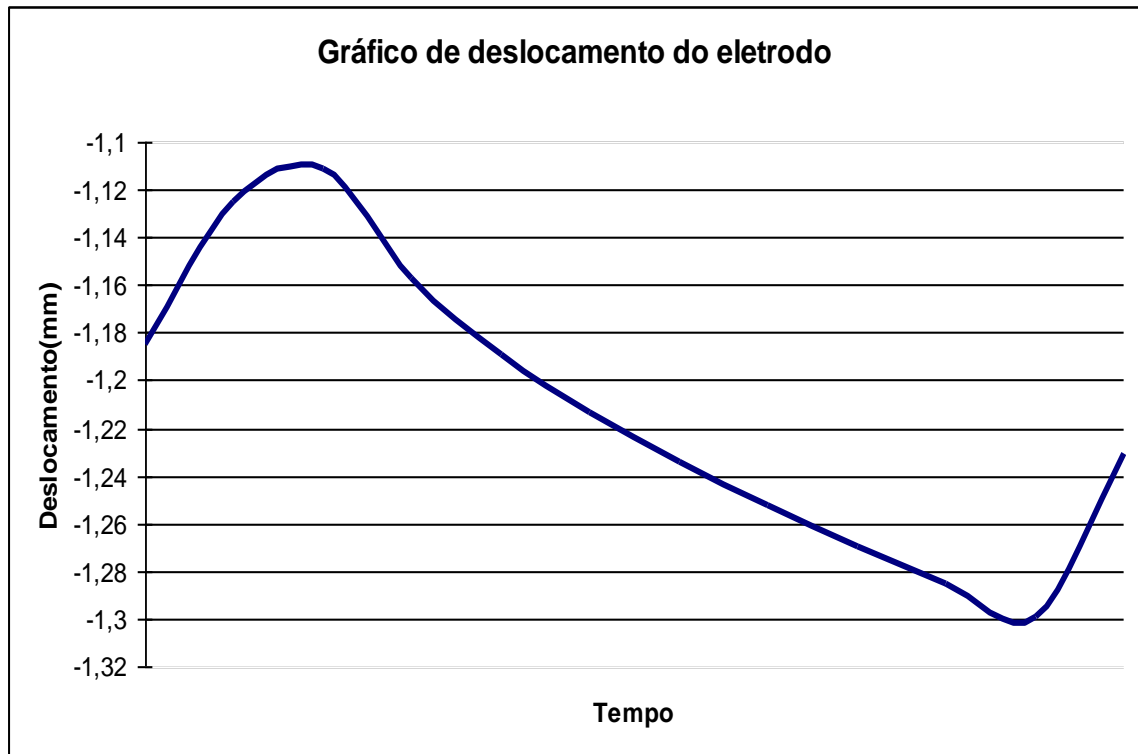
Figura 4. 15 – Curva de deslocamento do eletrodo durante a formação de um ponto de solda a partir do início da expansão térmica do material.
