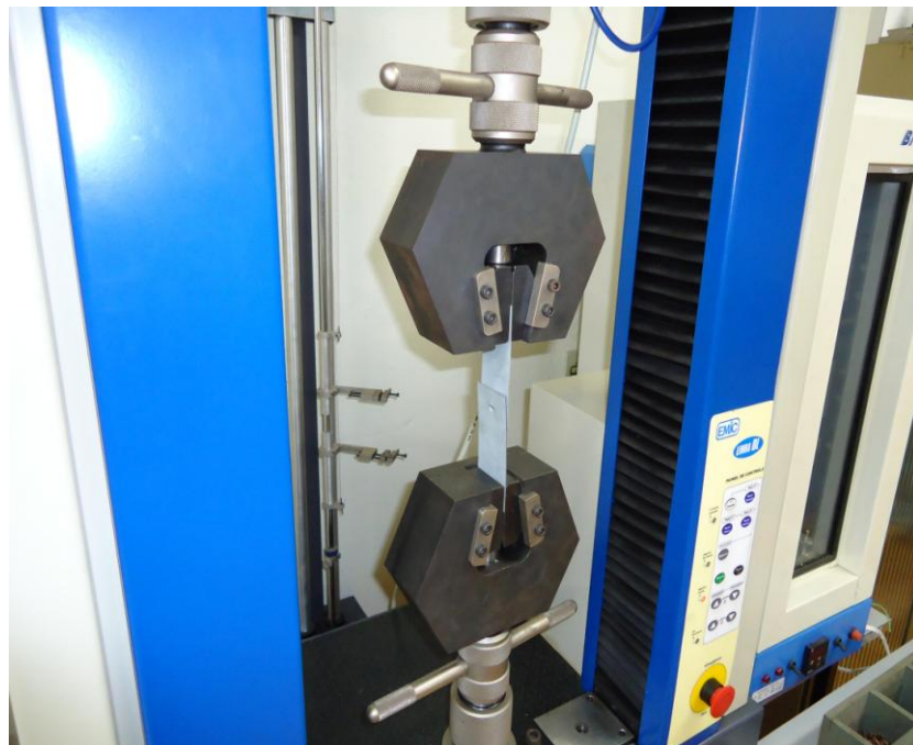
Figura 3.10 – Equipamento para realização do ensaio de cisalhamento.
