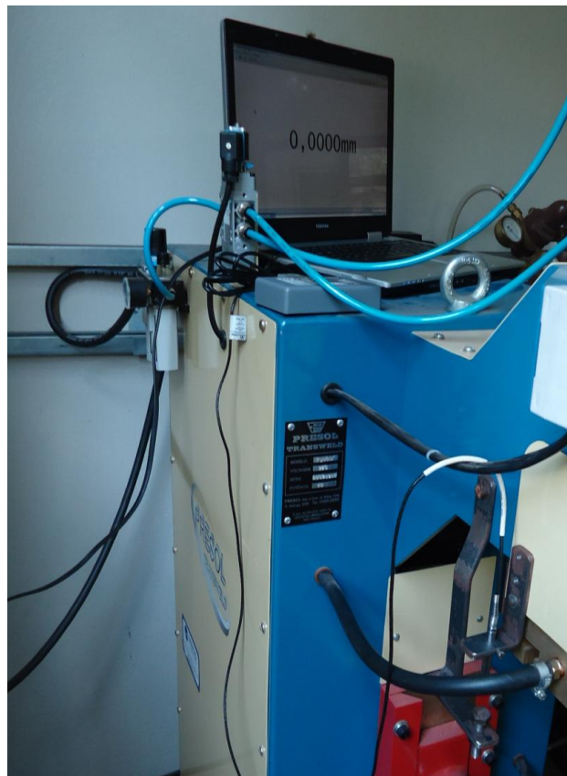
Figura 3.4- Posicionamento do sensor LVDT e condicionador de sinais para aquisição dos dados na máquina de solda a ponto.
