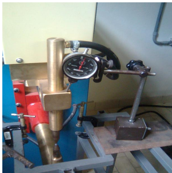
Figura 3.3 – Teste de deslocamento do eletrodo com relógio comparador analógico.
