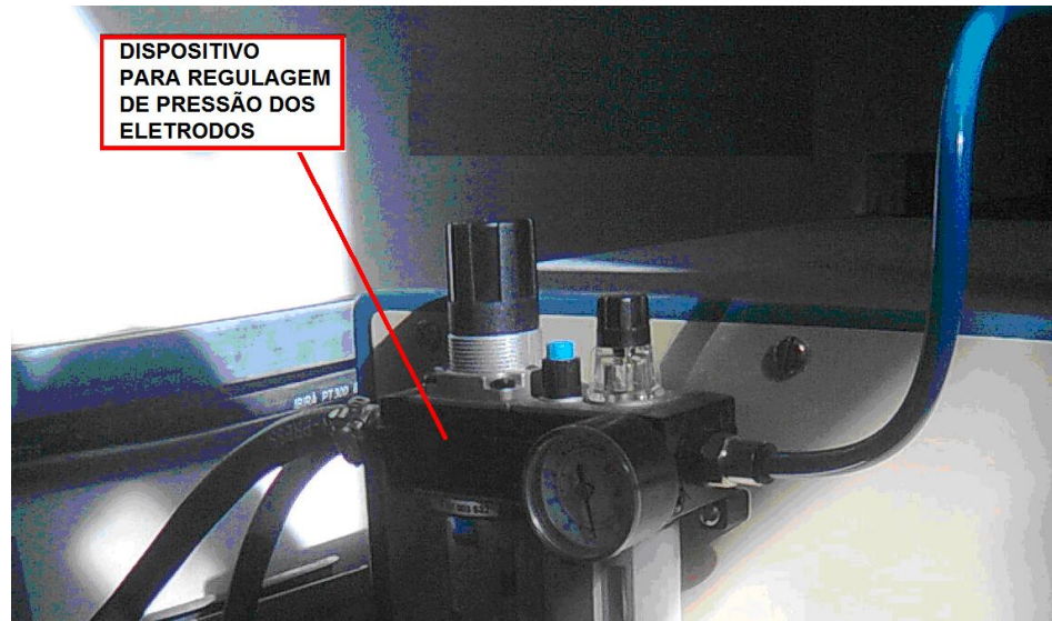
Figura 3. 2 – Dispositivo para regulagem de pressão.
