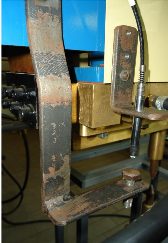
Figura 3.5- Fixação do sensor LVDT e da base de apoio.
