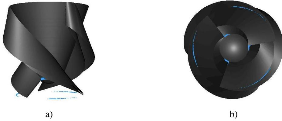
Figura 6.35 Iso-superfície da pressão de vapor da água, 2,337kPa, a 20°C, com vazão de 18m<sup>3</sup>/s para a geometria otimizada do rotor.
