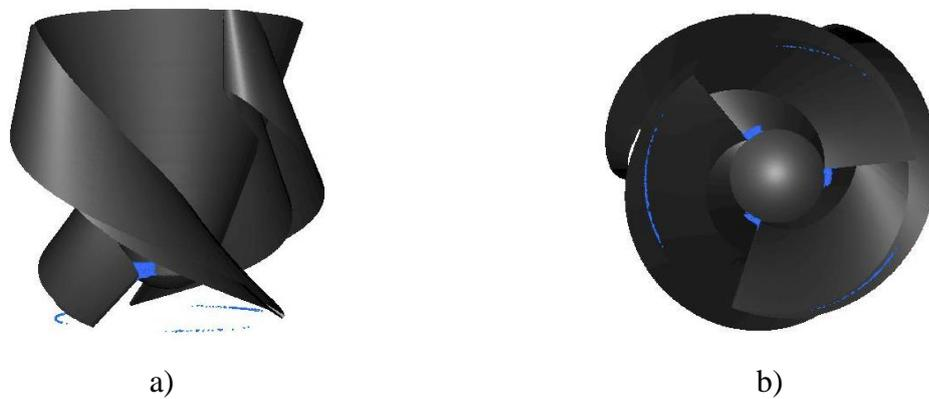
Figura 6.34 Iso-superfície da pressão de vapor da água,  $2,337\text{kPa}$ , a  $20^\circ\text{C}$ , com vazão de  $18\text{m}^3/\text{s}$  para a geometria inicial do rotor.
