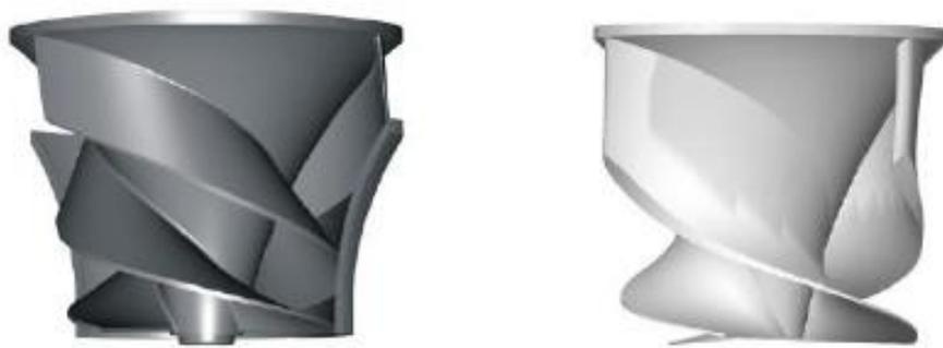
Figura 3.1 Rotores de turbinas amigáveis aos peixes. Hercker G. et al. (2012).
