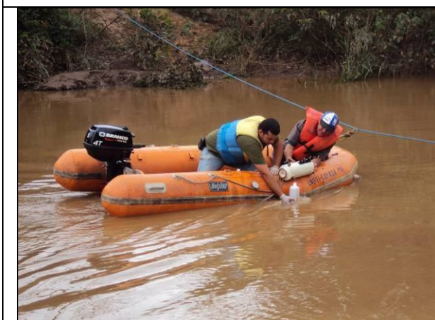
Figura 27. Foto da amostragem da água em regiões mais profundas com o auxílio da garrafa de VanDorn .
