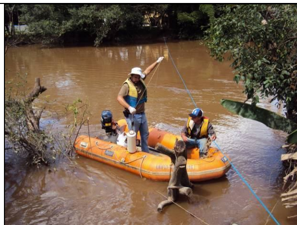
Figura 26. Foto da amostragem da água em regiões mais profundas com o auxílio da garrafa de VanDorn .
