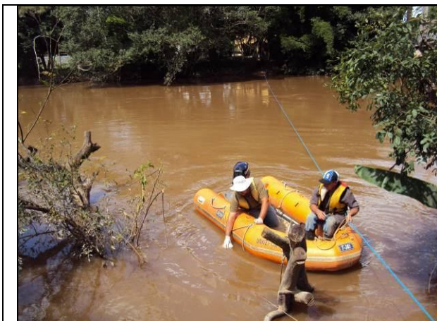
Figura 25. Foto da amostragem manual da água nas áreas de baixa profundidade.
