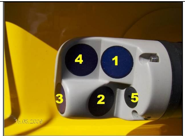
Figura 21. Foto dos sensores ultrassônicos do Qliner (1,2 e 3 – Sensores de Velocidade, 4 – Ecobatímetro e 5 sensor de pressão).
